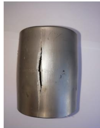
Şekil 5.29 7 numaralı basınçlı tüpün patlama basıncı-zaman grafiği ve prototip
