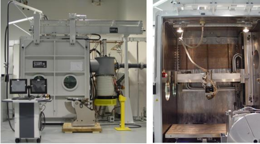
Şekil 5.1 EBW 88 kaynak tezgahına ait görüntü [28]
