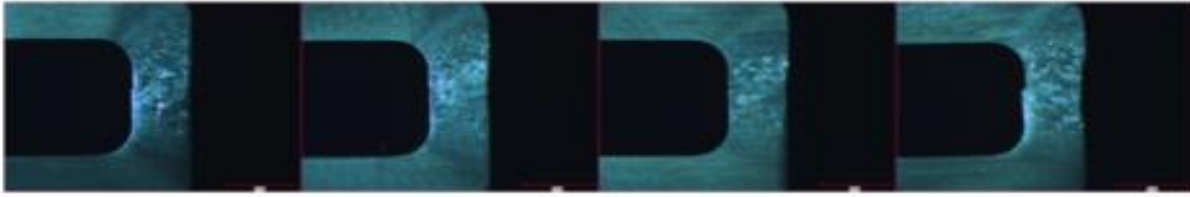
Şekil 5.50 Çizelge 5-6 Kupon 9 sırasıyla A,B,C ve D kesitleri X-ray makro görüntüleri (Ortalama KN: 2.55)
