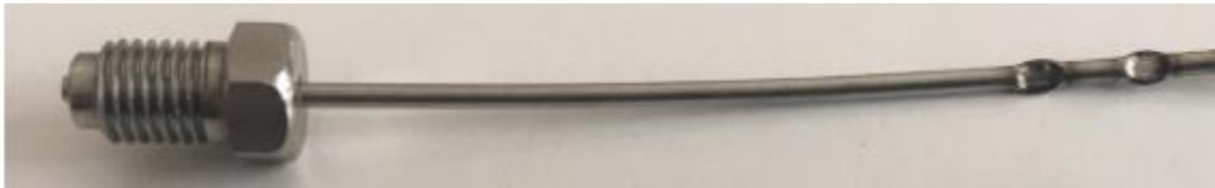
Şekil 4.1 1/16" lik kılcal borunun punta kaynağına ait görüntü
