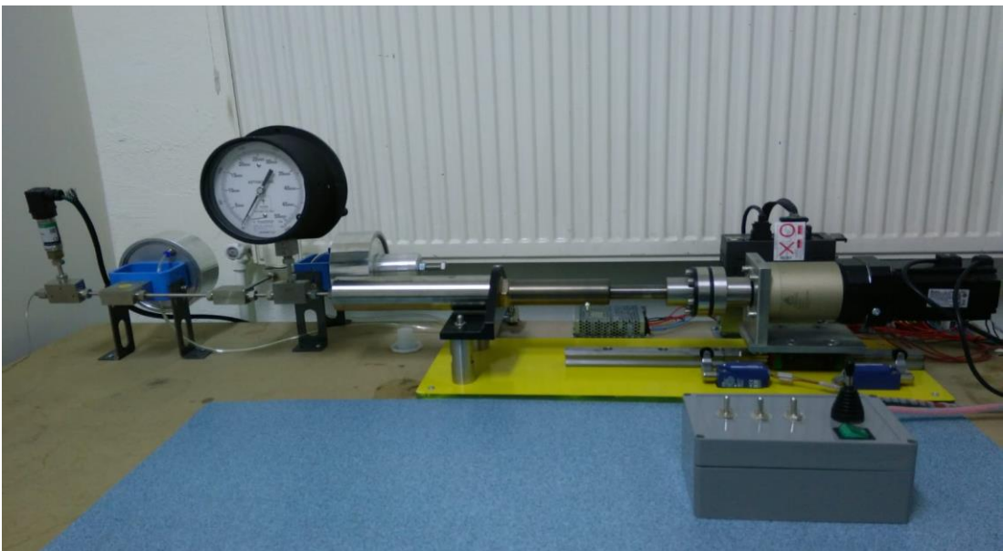
Şekil 4.3 Su ile patlatma test düzeneği fotoğrafı
