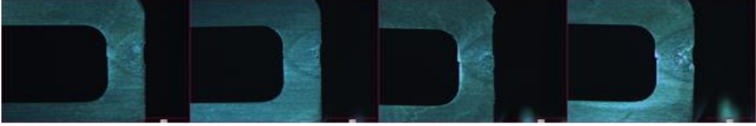
Şekil 5.44Çizelge 5-6 Kupon 3 sırasıyla A,B,C ve D kesitleri X-ray makro görüntüleri (Ortalama KN: 1.40)
