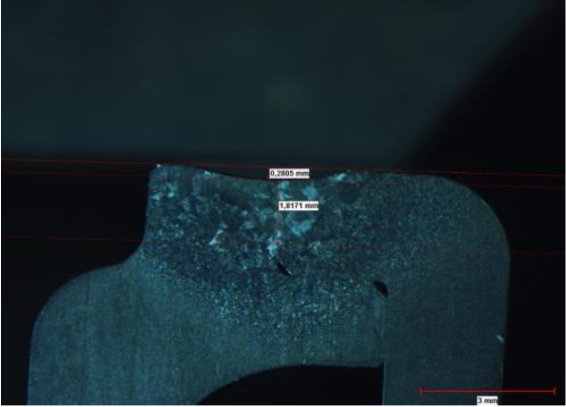
Şekil 5.16 Kupon 9 kesiti makro görüntü (KN: 1.82, KYÇ: 0.28) / Kaynak bölgesi 2
