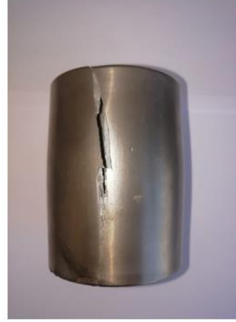
Şekil 5.24 2 numaralı basınçlı tüpün patlama basıncı-zaman grafiği ve prototip
