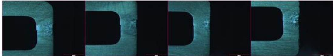
Şekil 5.46 Çizelge 5-6 Kupon 5 sırasıyla A,B,C ve D kesitleri X-ray makro görüntüleri (Ortalama KN: 1.39)
