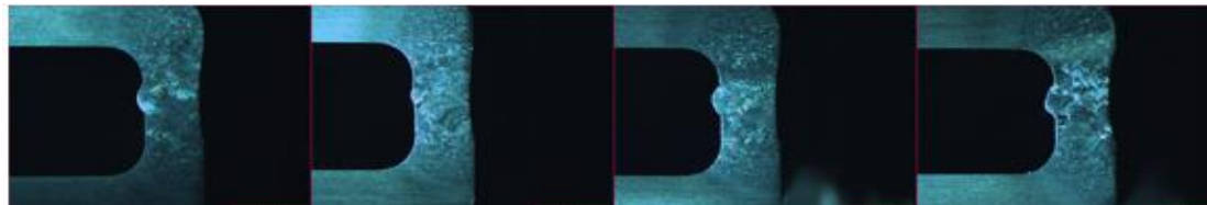
Şekil 5.47 Çizelge 5-6 Kupon 6 sırasıyla A,B,C ve D kesitleri X-ray makro görüntüleri (Ortalama KN: 2.58)
