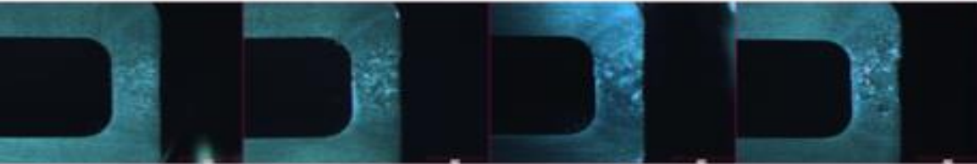
Şekil 5.51 Çizelge 5-6 Kupon 10 sırasıyla A,B,C ve D kesitleri X-ray makro görüntüleri (Ortalama KN: 2.38)
