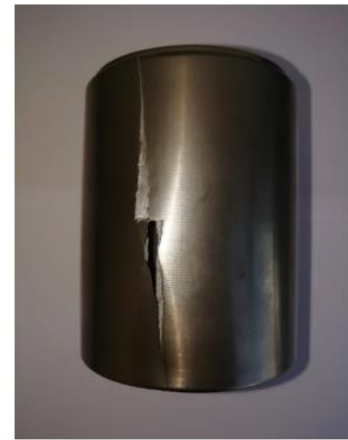
Őekil 5.23 1 numaralı basınçlı tüpün patlama basıncı-zaman grafiđi ve prototip
