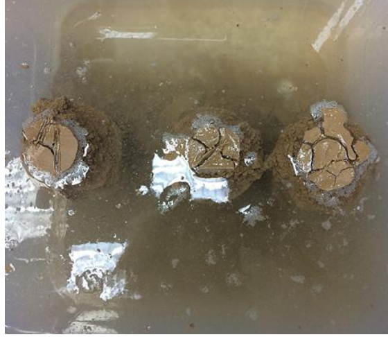
Şekil 4.28. İlk 10 dk içinde toprak örneklerinin üst kısımlarında başlayan dağılmalar.
