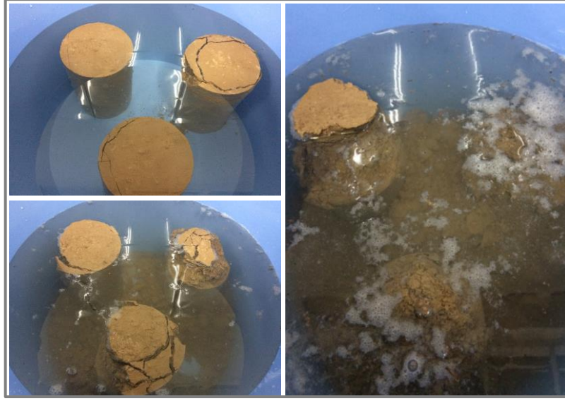
Şekil 4.30. %15 cam tozu katkılı örneklerin ıslanma döngüsü aşamasında dağılmaya başlaması.
