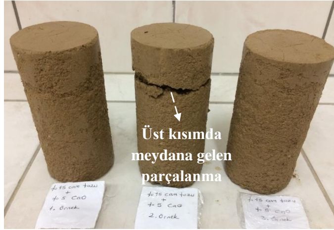
Şekil 4.35. %15 cam tozu+%5 CaO katkıli örnekler 2. İslanma-kuruma döngüsü aşamasında sudan çıkarıldığında.
