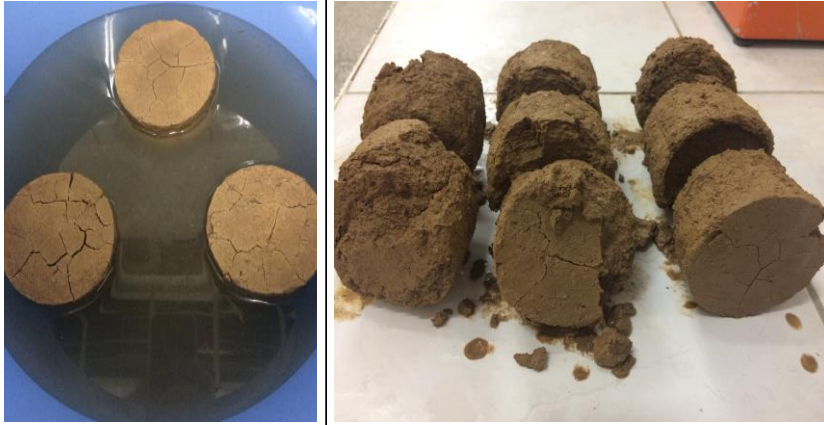
Şekil 4.33. %15 cam tozu+2M NaOH katkılı örneklerin 2. döngü ıslanma aşaması ve sudan çıkarıldığında oluşan parçalanmalar.
