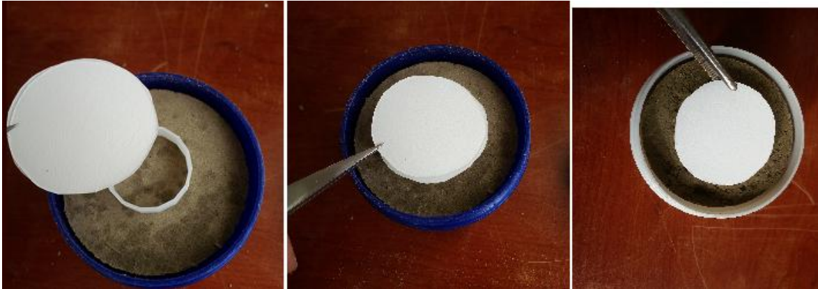
Şekil 5.20 Filtre kağıtlarının plastik ring üzerine yerleştirilmesi.
