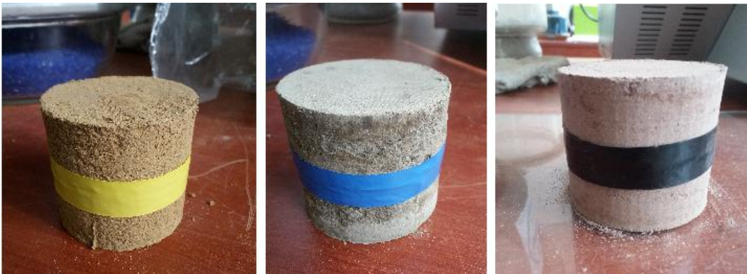
Şekil 5.18 Zemin numunelerinin bantlanması.
