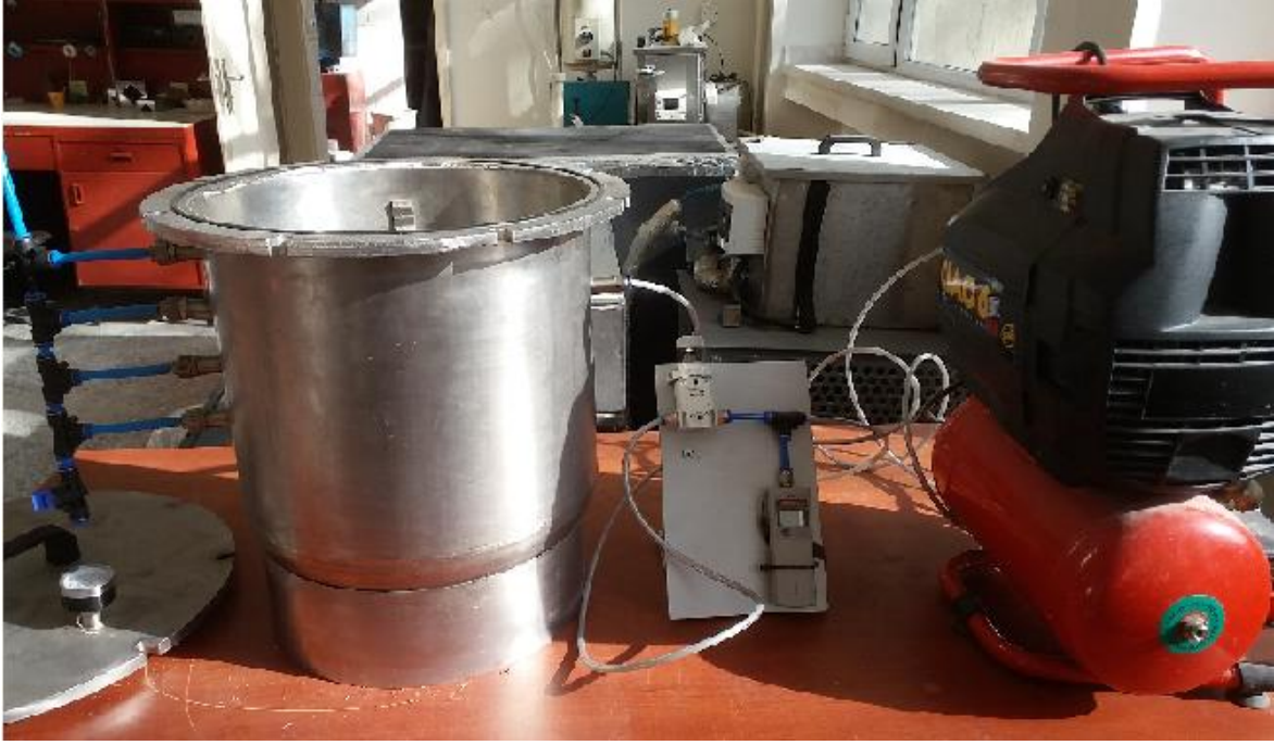
Şekil 5.28 Laboratuvarda kullanılan basınç plakası deney düzeneği ekipmanları.
