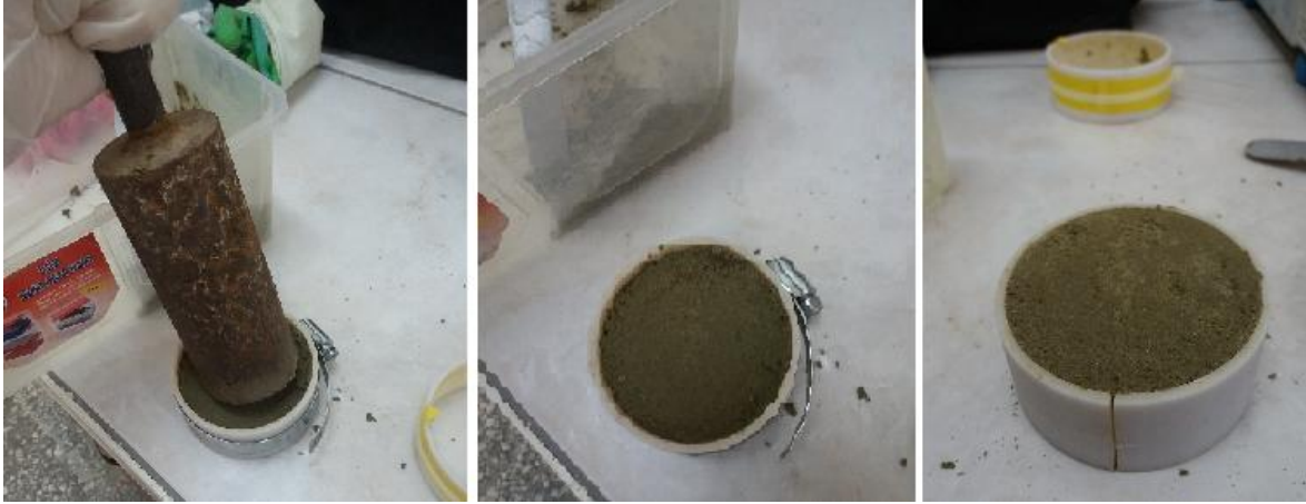
Şekil5.15 Örneklerin sıkıştırılması ve ringden çıkarılması.
