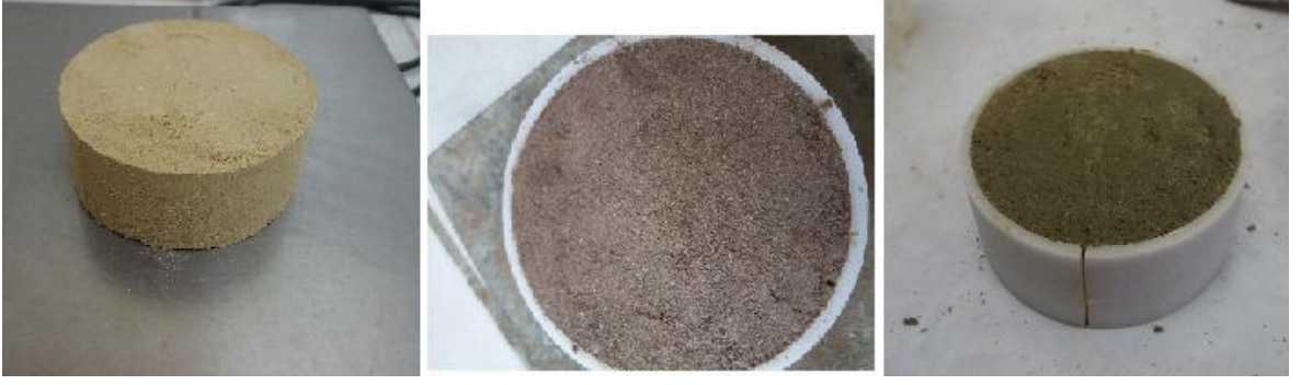
Şekil 5.13 Filtre kağıdında kullanılan örneklerin hazırlanması.
