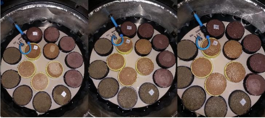
Şekil 5.31 Seramik disk üzerindeki zemin numunelerinin saf su ile doyurulma aşamaları.
