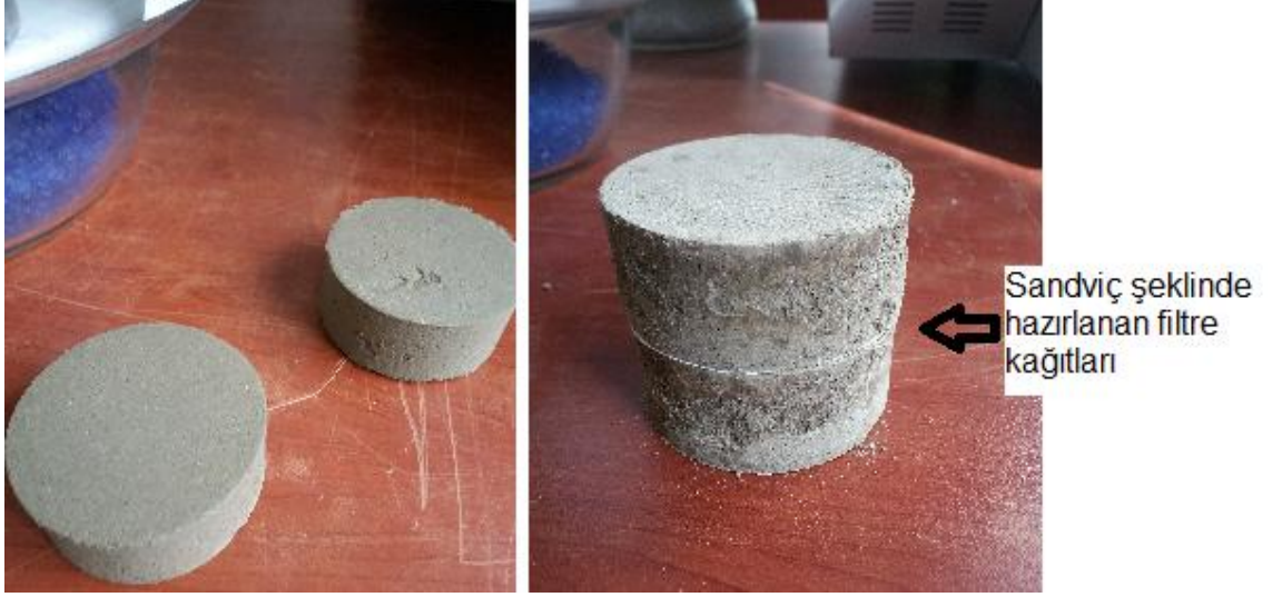
Şekil 5.17 Filtre kağıtlarının zemin numuneleri arasına yerleştirilmesi.
