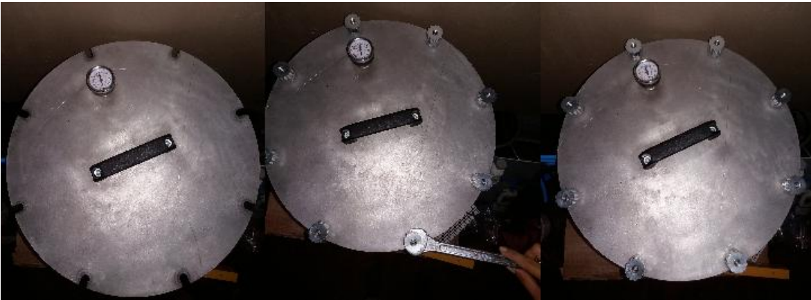
Şekil 5.32 Basınç tenceresinin vidalarının sıkılması.
