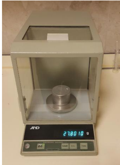
Şekil5.23 Alüminyum kapların soęuk daralarının ( T_c ) alınması.
