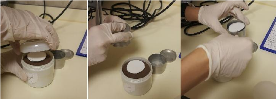
Şekil 5.25 Ring üstündeki filtre kağıtlarının alüminyum kutulara alınması.
