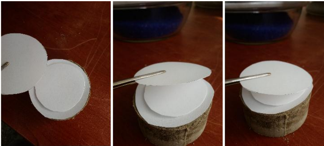
Şekil 5.16. Filtre kağıtlarının sandviç şeklinde hazırlanması.
