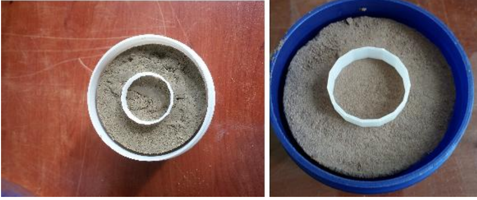
Şekil 5.19 Zemin numunesi üzerine plastik ring yerleştirilmesi.
