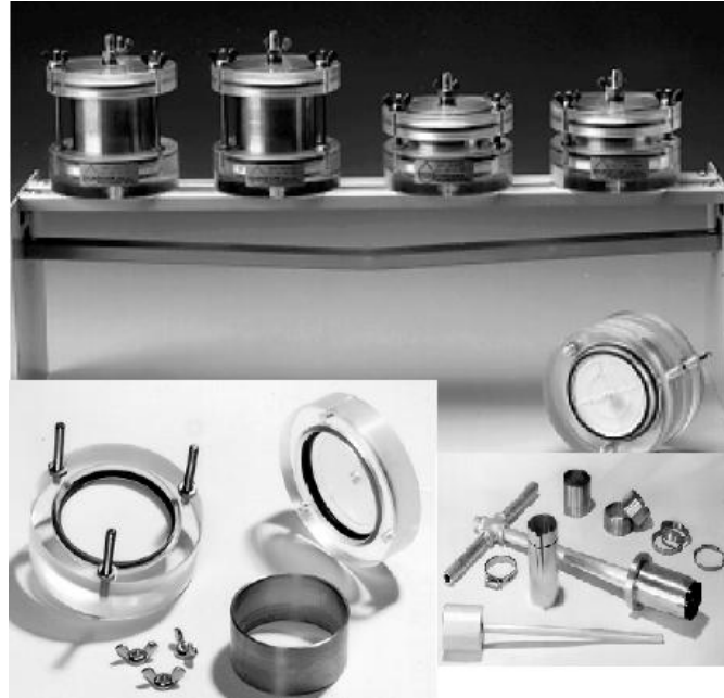
Şekil 2.2 Tempe basınç hücresi [8].
