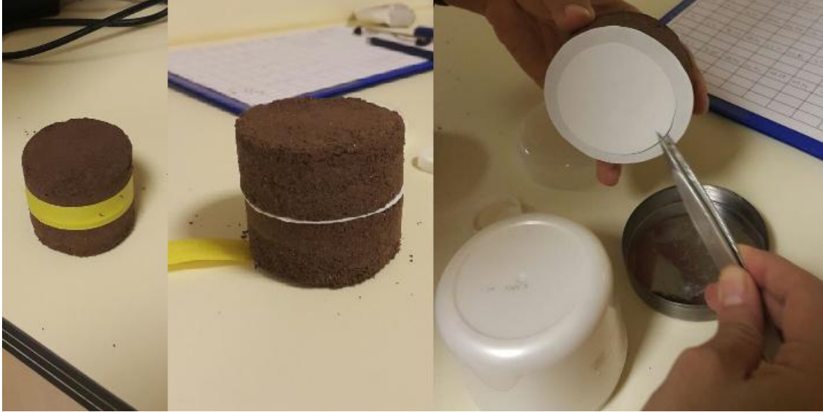
Şekil 5.26 Ortadaki filtre kağıdının kutu içerisine alınması.
