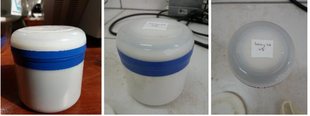
Şekil 5.21 Kavanoz kapaklarının sıkıca bantlanması.
