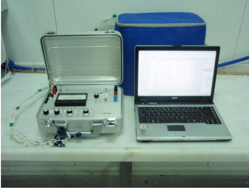
Şekil 2.1 Saykrometre deney düzeneği (Mikrovoltmetre, bilgisayar ve termos çanta).
