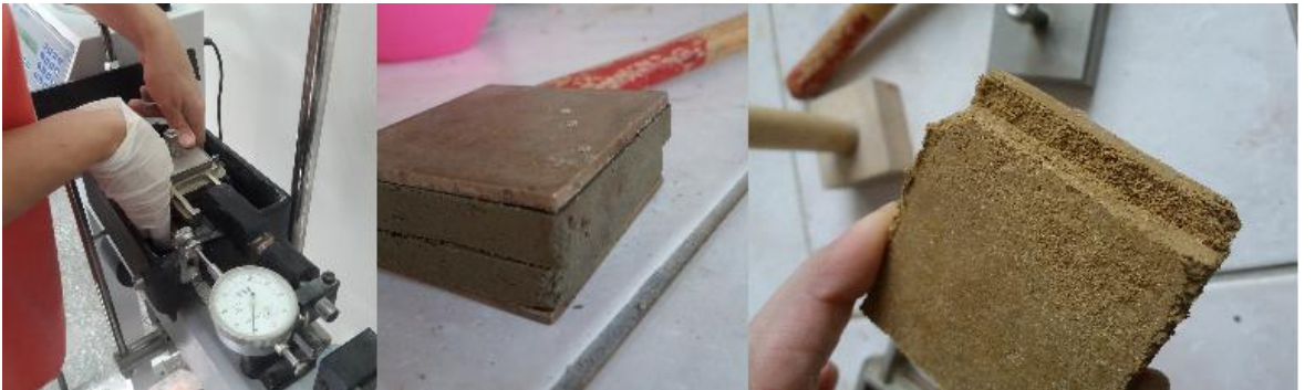
Şekil 5.10 Makaslanan zemin numunesinin deney sonrası görünümü.
