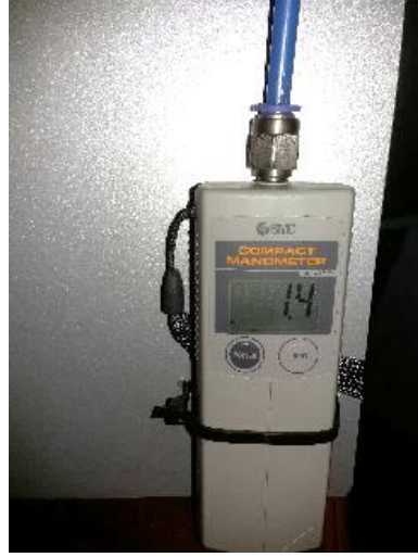
Şekil 5.33 Basınç plakası deneylerinde kullanılan manometrenin yakından görünümü.
