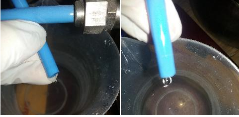
Şekil 5.34 Tahliye borusundan su çıkışının gözlemlenmesi.
