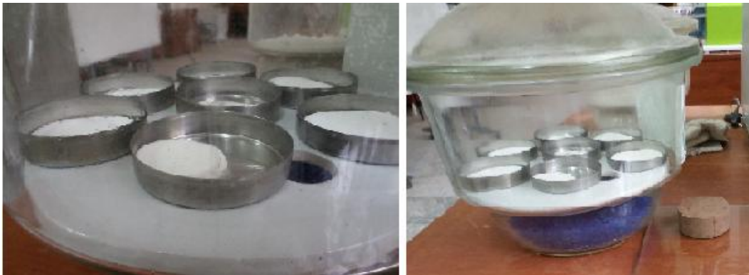
Şekil 5.14 Filtre kağıtlarının nem almasını önlemek amacıyla desikatörde bekletilmesi.
