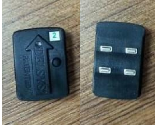
Şekil 3.3. Kablosuz yüzeyel EMG sensörünün ön ve arka yüzeyinin görünümü.
