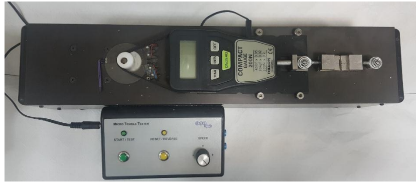
Şekil 3.11. Mikro gerilim bağlanma dayanıklılık test cihazı.
