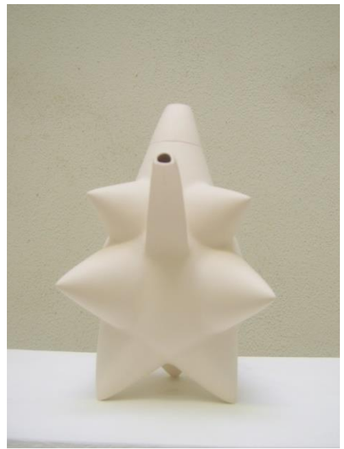
Resim 40: Bisküvi pişirimi yapılmış çaydanlıklar
