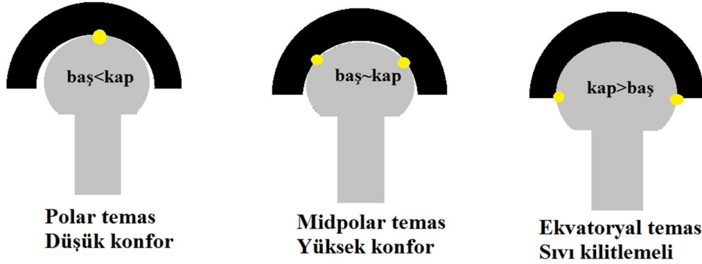
Şekil 2.22 Aralık mesafesine göre temas çeşitleri. En uygun aşınma karakteristikleri mid-polar temasta görülür.
