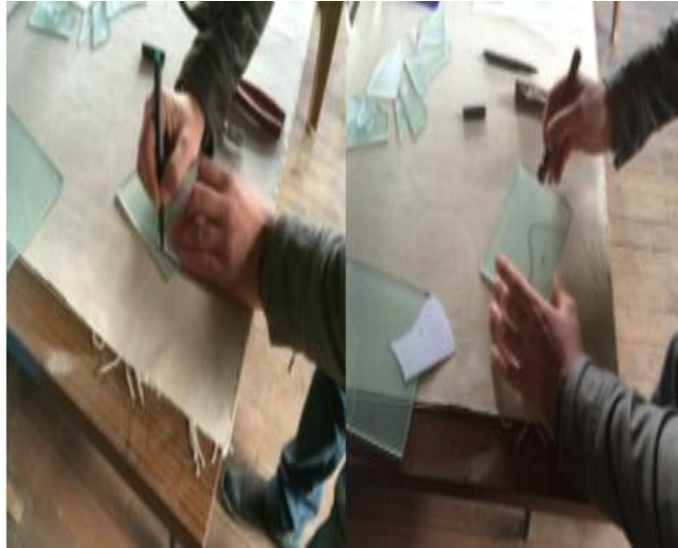
Görsel 30. Füzyon Vitray Tekniđi, Çizme ve kesme aşaması
