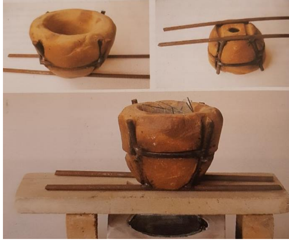
Görsel 15. Bilgehan Uzuner, 2004, Potalı Akıtma Döküm Tekniği
