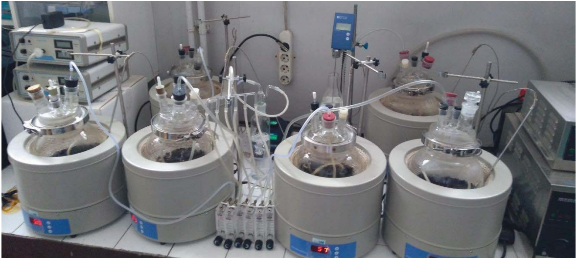
Şekil 3.5. ISO 14855-1:2013 standardında hazırlanan kompostlaştırma deney düzeneği
