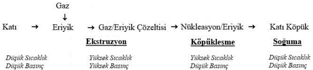
Şekil 2.18. Tipik bir köpük ekstrüzyon işleminde hal değişikliği[53]
