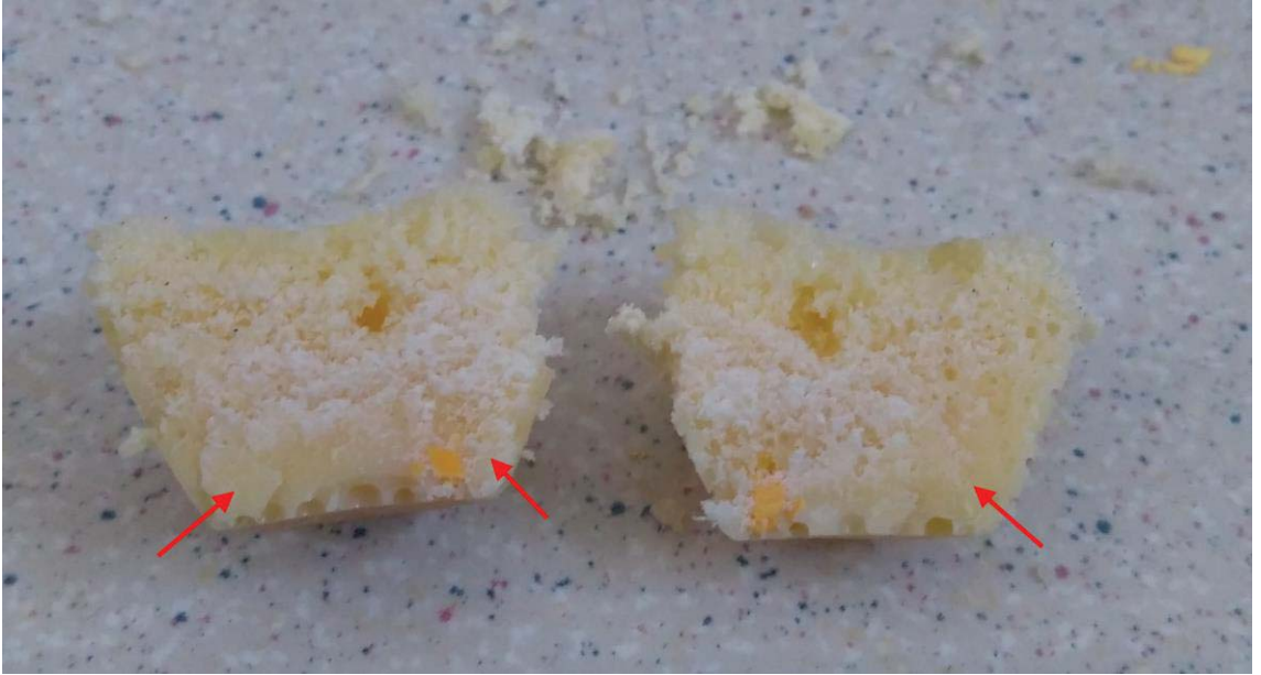
Şekil 4.1. Kesikli sistemde üretilen PBAT köpük örneği
