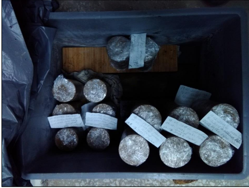
Şekil 28 Kürlenme amaçlı nem havuzunda bekleyen numunelere ait bir görüntü.
