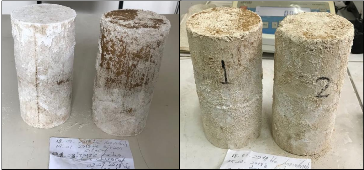
Şekil 29 Oda şartlarında bekletilen %10 NaOH çözeltili örneklerin görüntüleri.
