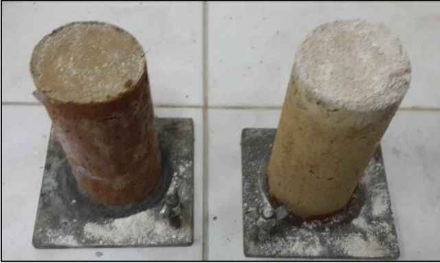
Şekil 49 Büzülmenin tayin edilmesi amacıyla hazırlanan örneklere ait görüntüler.
