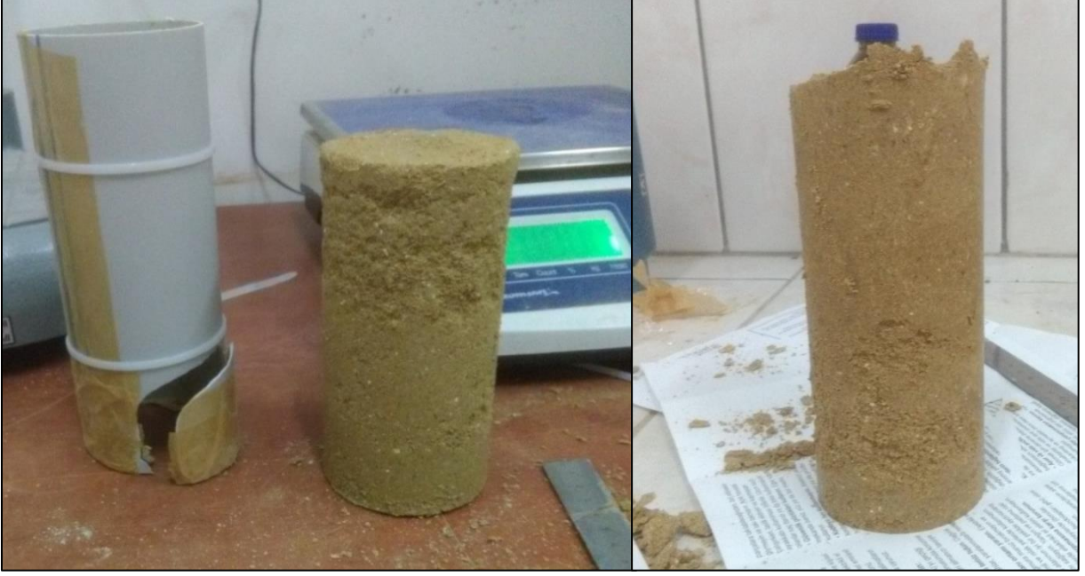
Şekil 26 Plastik kap kullanarak numune hazırlarken karşılaşılan olumsuzluklar.
