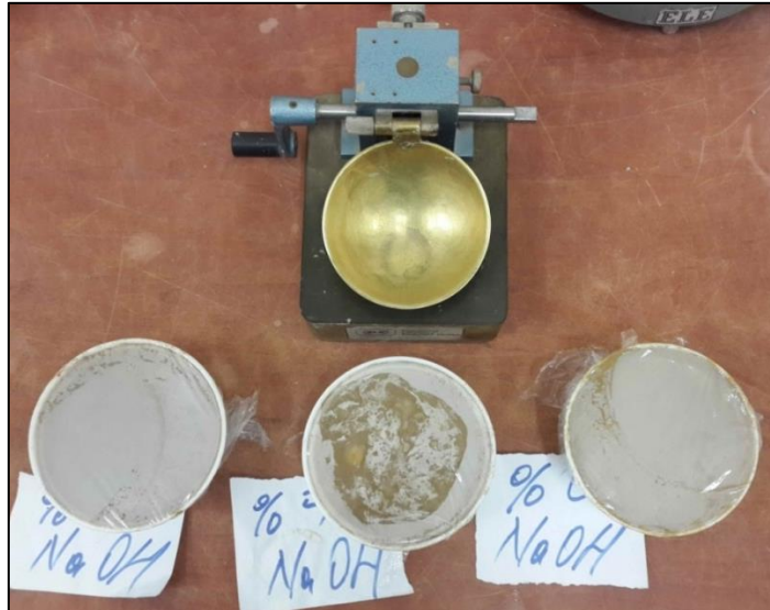
Şekil 17 Kürlenmesi için bekletilen likit limit numuneleri.
