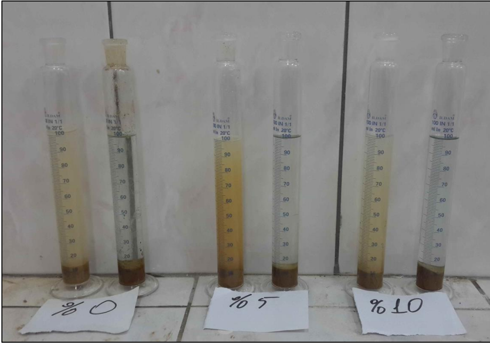
Şekil 25 Serbest şişme indeksi deneyi görüntüsü.
