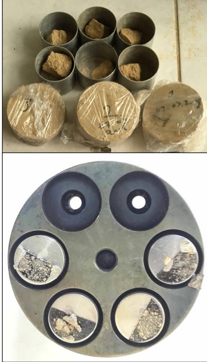
Şekil 70 SEM ve su içeriği tayini için alınan örnekler için görüntüler.
