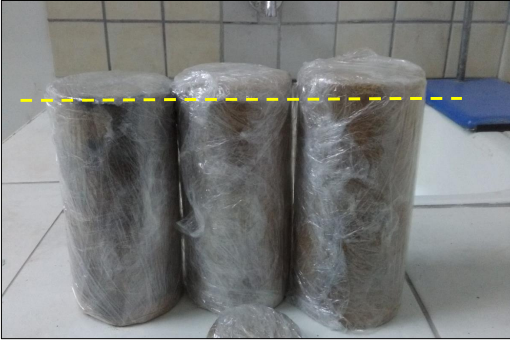
Şekil 27 Plastik kalıp kullanarak hazırlanmış numuneler arasındaki boy farkları.
