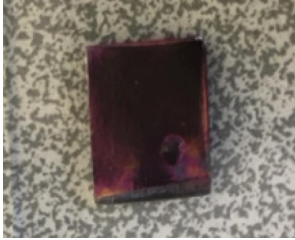
Şekil 4.12. Akımsız kaplama metodu ile altın biriktirilen yüzeyin fotoğrafı.
