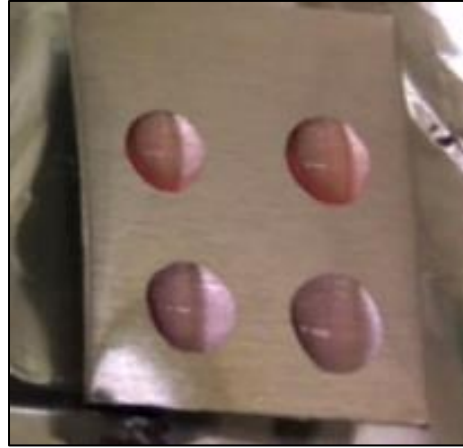
Şekil 4.33. Alüminyum yüzeyde koloidal altın damlaların görüntüsü
