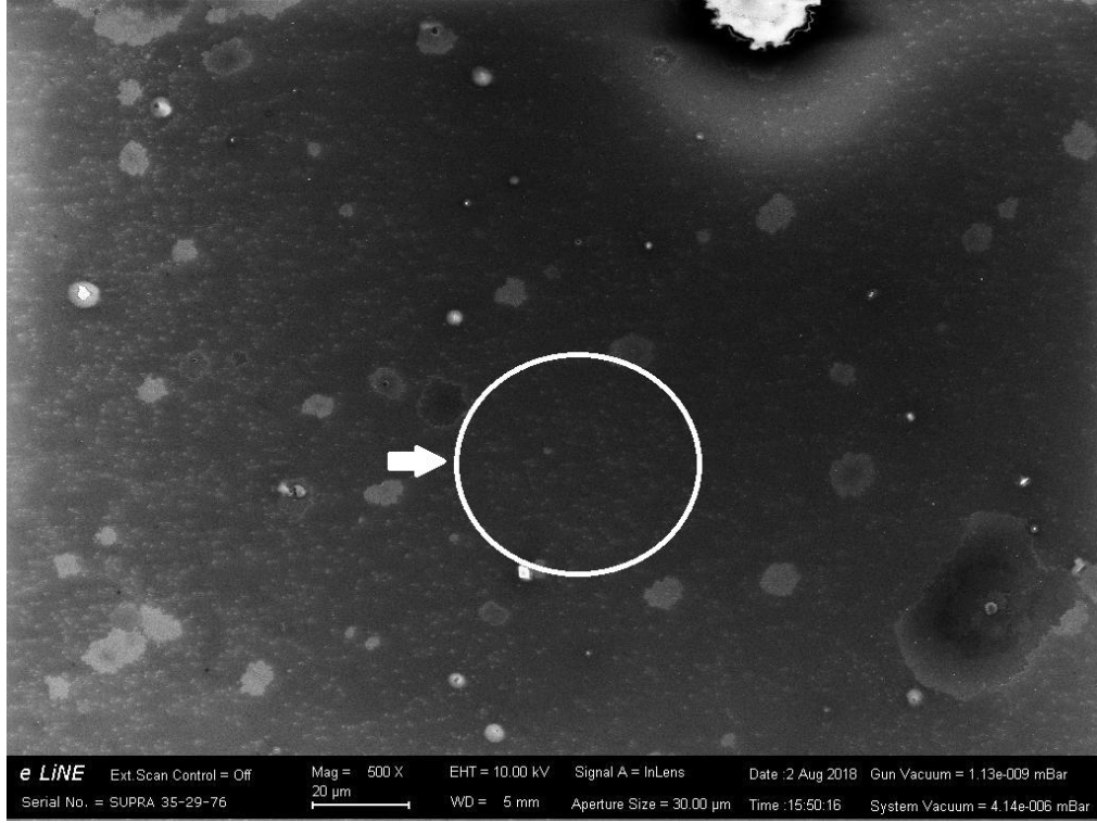
Şekil 27. 400°C'de 7 saat tavllanmış örnekten alınan SEM görüntüsü
