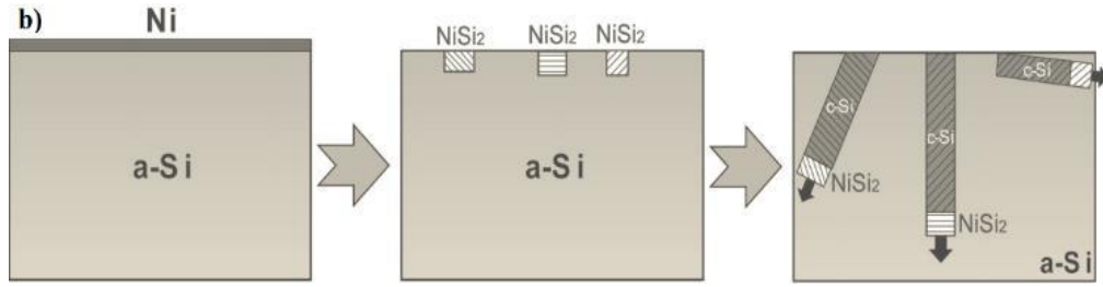
Şekil 4. Silisit oluşturan bu sistemde gerçekleşen kristalleşme mekanizması [14]
