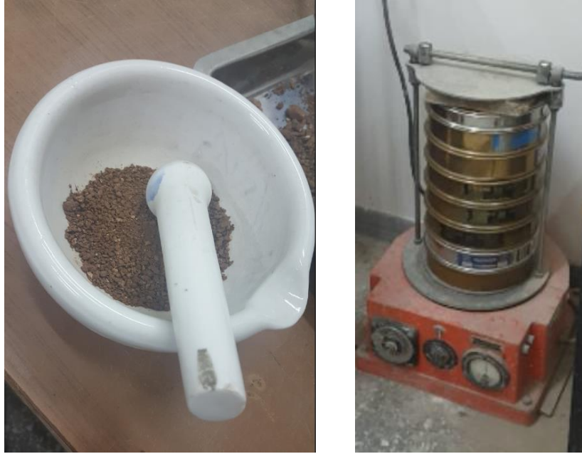
a) b) Şekil 3.13: Toprak ve kum malzemelerin toz hale getirilmesi sırasında a) Öğütme b) Eleme İşlemlerinin Yapılışı
