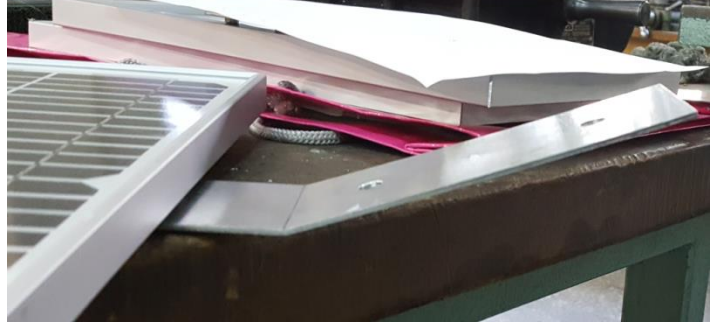
Şekil 3.4: Uygun açılarda bükülmüş panel montaj elemanları
