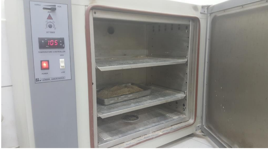
Şekil 3.14: Kum örneğin fırında kurutulması işlemi
