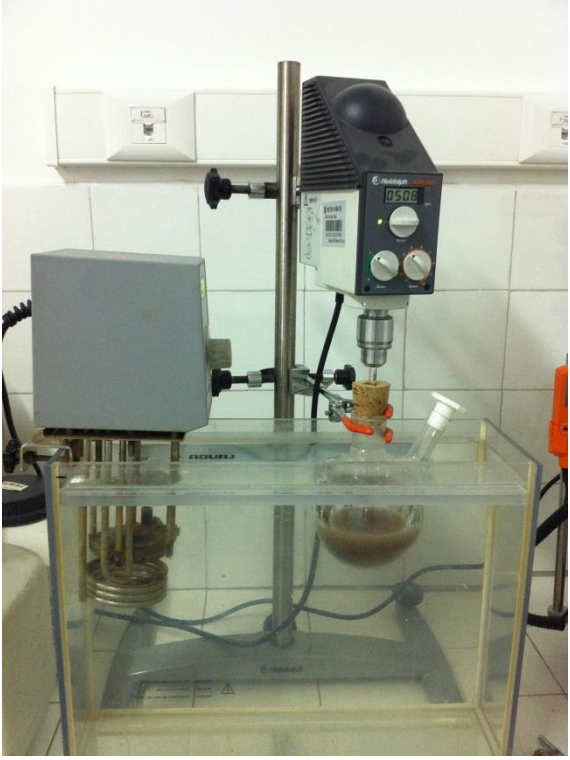
Şekil 3.2. Fe(III) iyonları baskılanmış PHEMAGA nanopartiküllerin hazırlanmasında kullanılan polimerizasyon sistemi.
