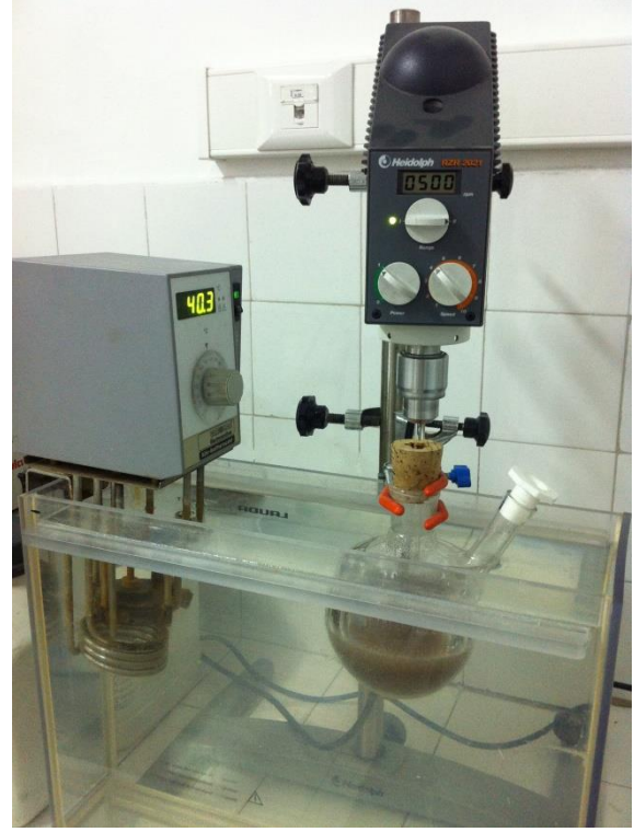
Şekil 3.2. Fe(III) iyonları baskılanmış PHEMAGA nanopartiküllerin hazırlanmasında kullanılan polimerizasyon sistemi.
