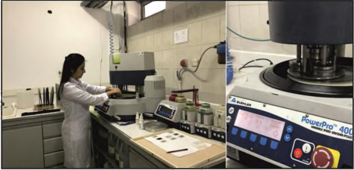
Şekil 2.5. Parlatma cihazında ince kesit örneklerinin parlatılması işlemi.
