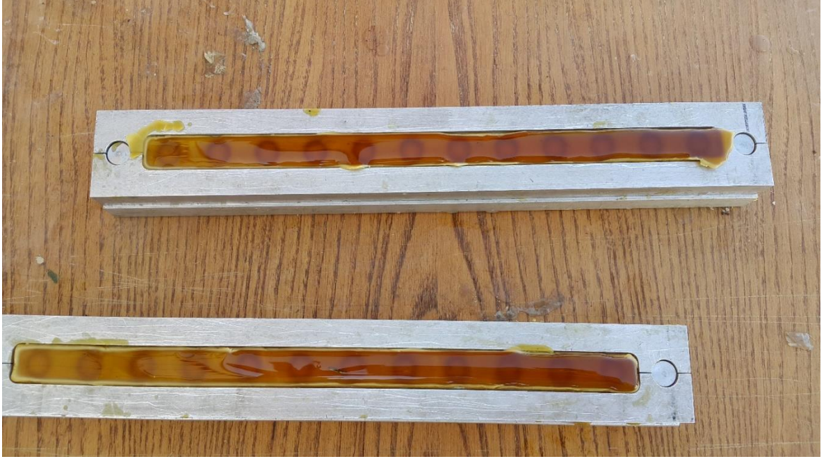
Şekil 3.4. Eriyik haldeki balmumu dökülmüş çelik yüksük kalıpları ( Fotoğraf: Betül Rabia Karakoç )
