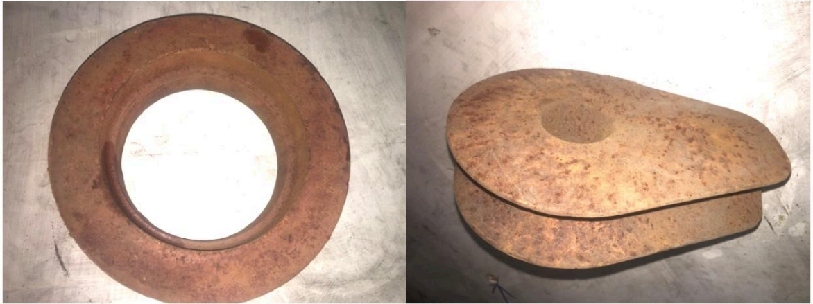
Şekil 4. 22. Akpınar Döküm ve Makina Sanayi A.Ş. tarafından boyanan metal parçaların iki yıl doğal depo ortamında bekletilmeleri sonucu yüzeylerinde gözlenen korozyon
