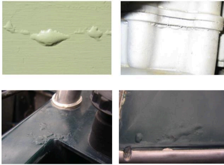
Şekil 4. 21. Metal ve alaşımların yüzeyinde blister oluşumu [43].
