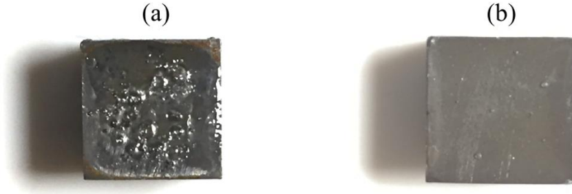
Şekil 4. 12. (a) 110 °C'de, (b) 90 °C'de yürütülen polimerizasyonlar neticesinde yüzey kaplamasında görülen kabarmalar.
