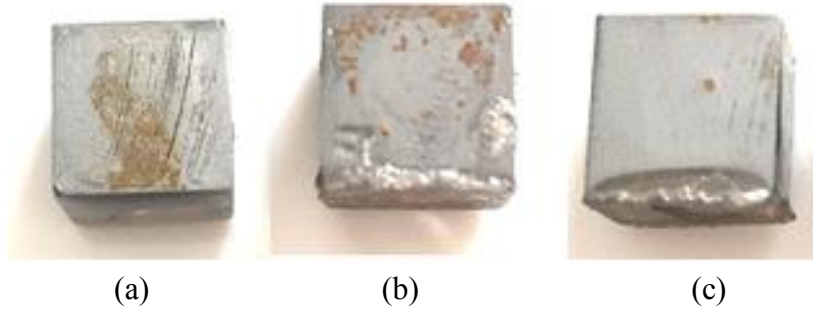
Şekil 4. 23. 240 saat aşınma testi sonrası BADGE:TEPA (2:1) reçinesi yapısında korozyon inhibitörü olarak BTA'nın etkisi (a) BTA eklenmemiş numune, (b) BADGE:BTA = 300:1, (c) BADGE:BTA = 100:1
