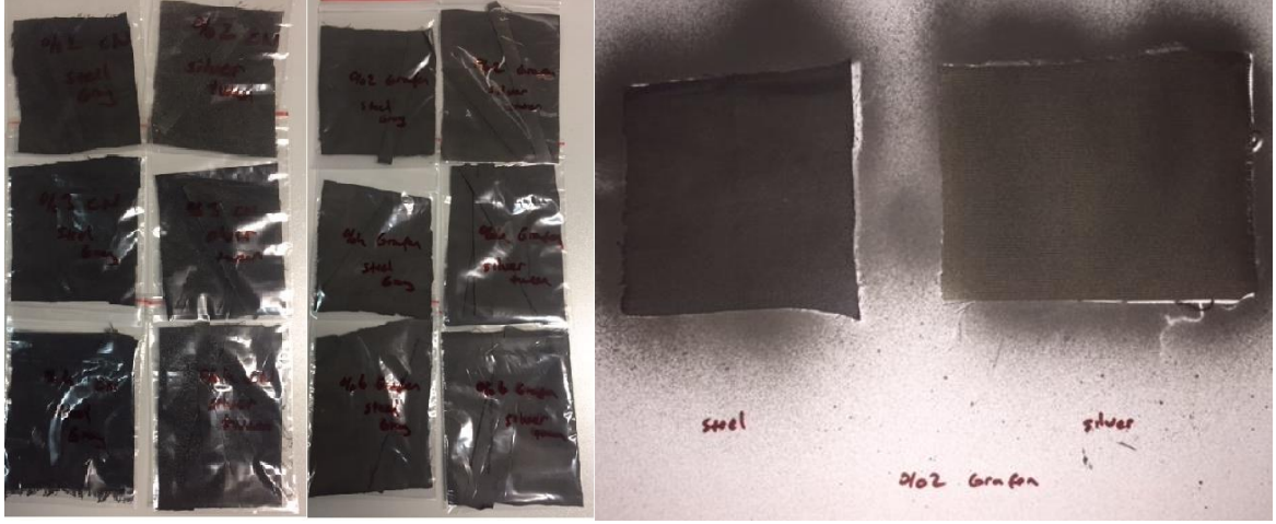
Şekil 5.1. CN ve Grafen Katkılı Plastomer Kaplanmış Kumaş Örnekleri ve Püskürtme - Tarama İşlemi İle Elde Edilen Daha Büyük Formda Kaplanan Kumaş Örnekleri
