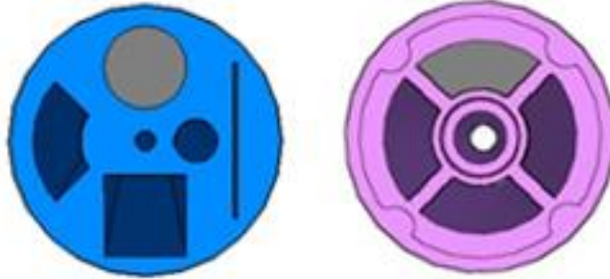
Şekil 3.23. Kalite kontrol aplikatörü (solda) ve YA-BRT aplikatöründe (sağda) kompensatuar malzemelerin yerleşimine ait aksiyal görüntü.
