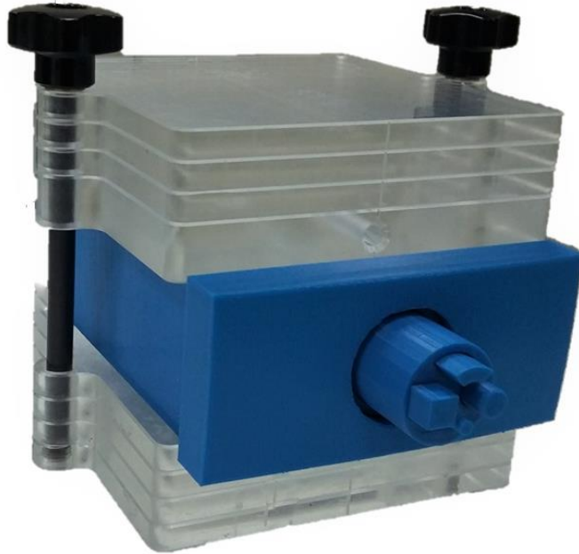
Şekil 3.21. Kalite kontrol testlerinin yapılması amacı ile tasarlanan fantom düzeneği.
