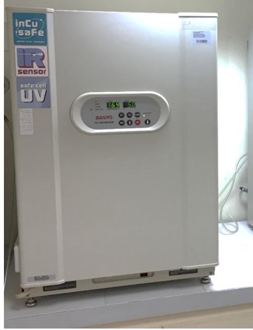
Şekil 3.13. Sanyo MCO-18 model hücre kültür inkübatörü
