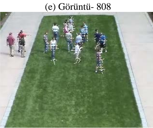
Şekil 3.2 Sahne-1’de normal ve anormal durumlar sırasında, Horn-Schunck yöntemi ile elde edilen optik akışların gösterimi (a) (c) (e) Normal olaylar sırasında elde edilen optik akışlar (b) (d) (f) Anormal olaylar sırasında elde edilen optik akışlar. Anormal olaylar sırasında elde edilen akış vektörleri, normal olaylar sırasında elde edilenlere göre daha büyük değerlere sahiptir.
