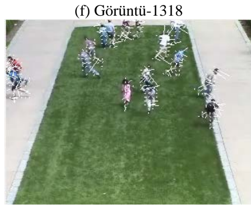
Şekil 3.2 Sahne-1’de normal ve anormal durumlar sırasında, Horn-Schunck yöntemi ile elde edilen optik akışların gösterimi (a) (c) (e) Normal olaylar sırasında elde edilen optik akışlar (b) (d) (f) Anormal olaylar sırasında elde edilen optik akışlar. Anormal olaylar sırasında elde edilen akış vektörleri, normal olaylar sırasında elde edilenlere göre daha büyük değerlere sahiptir.
