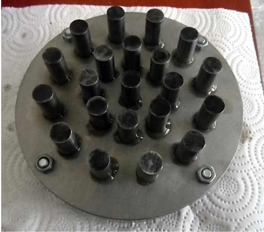
Şekil 5.16. Kalıba yük bindirme çubuklarının yerleştirilmesi
