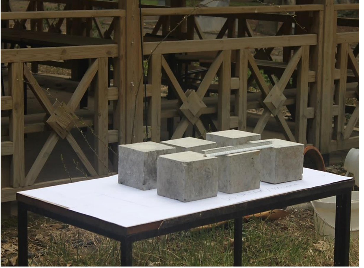
Şekil 6.7. Dış ortam deneyine maruz bırakılmış beton numuneler (Hacettepe Üniversitesi Jeoloji Mühendisliği Bölümü orta bahçe)
