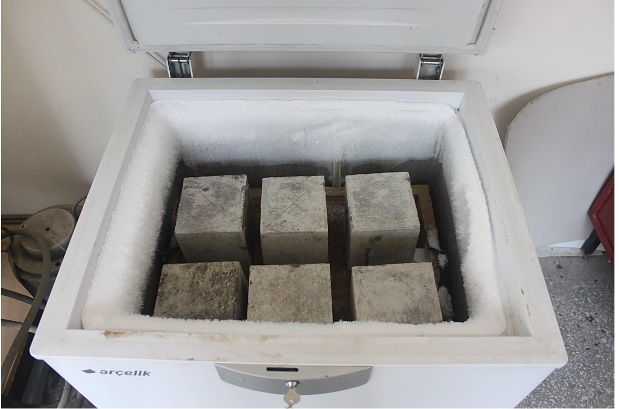
Şekil 6.4. Donma-çözülme deneyine maruz bırakılmış beton numuneler
