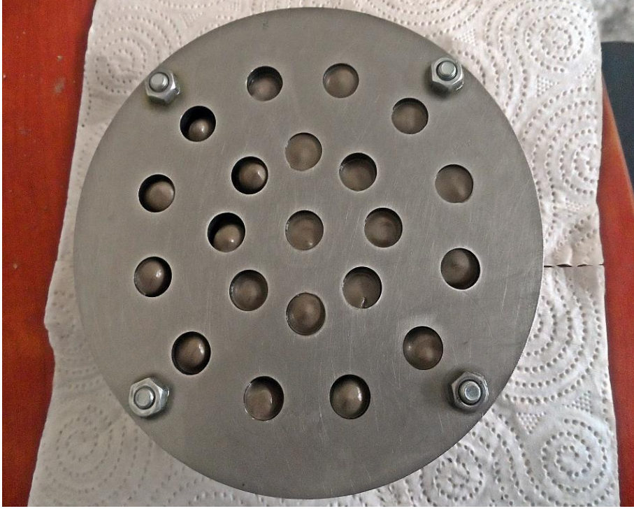
Şekil 5.15. Uçucu kül karışımının kalıbın agrega haznesine eklenmesi
