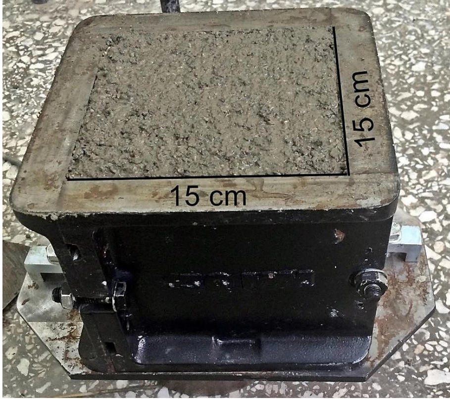
Şekil 6.1. Karışımın beton kalıba dökülmesi
