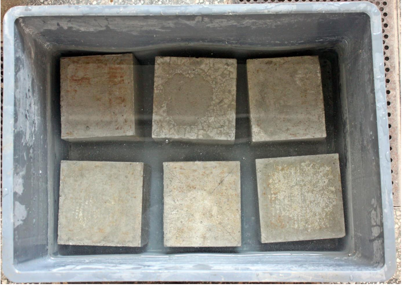
Şekil 6.6. Islanma-kuruma deneyine ait beton numunelerin kür havuzundaki görünümü
