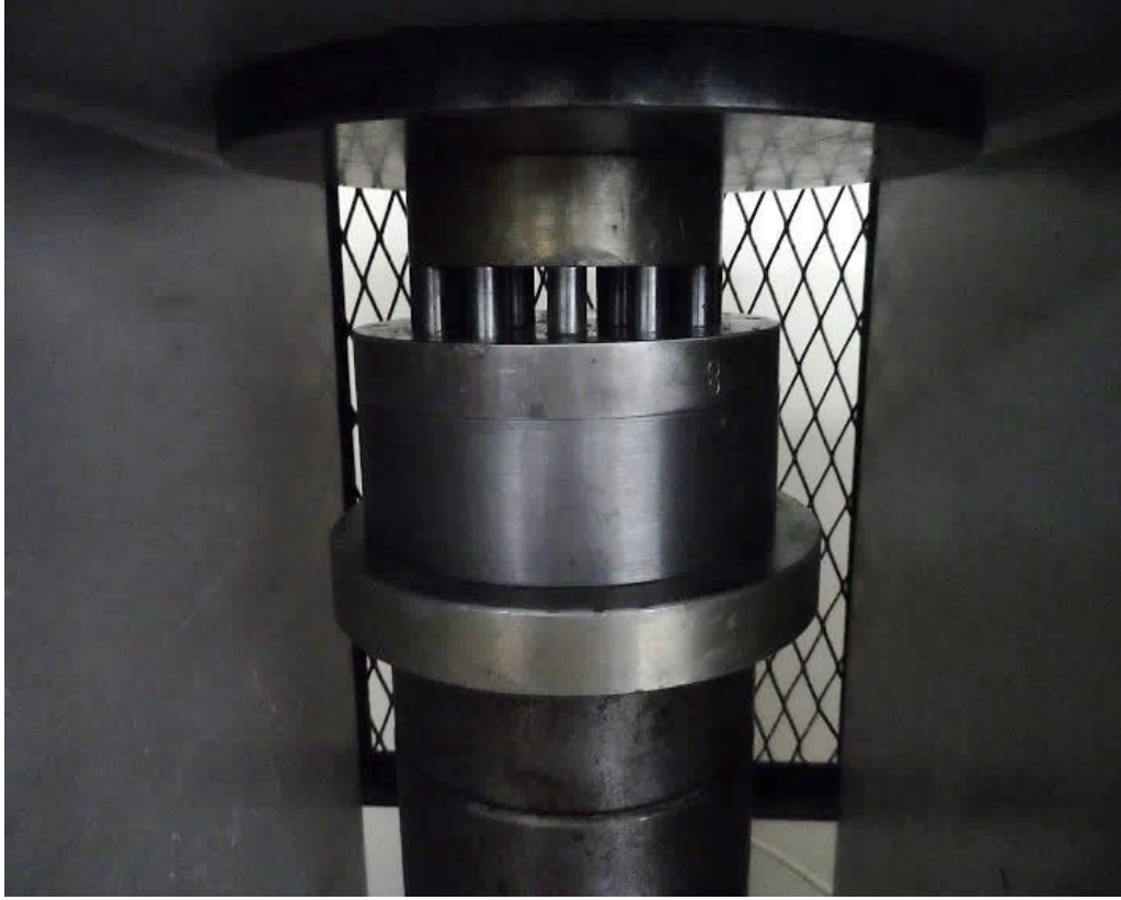
Şekil 5.19. Presleme ile agregaların üst plakadan çıkarılışı
