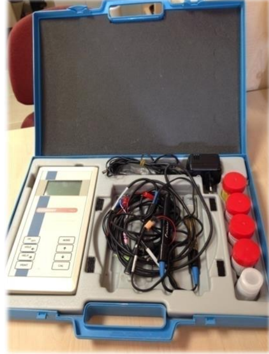
Şekil 4.1. Arazilerde Kullanılan CONSORT Marka Arazi Tipi Su Ölçüm Cihazı
