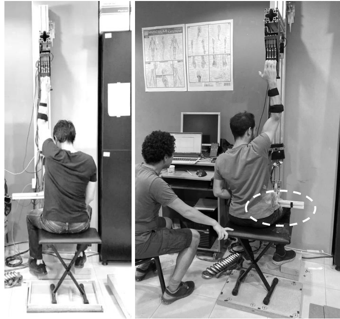
Şekil 3.6. Test pozisyonu ve pozisyonlar arası geçişlerde gövde, omuz, kol postürünün ayarlanması için kullanılan ayarlı oturak ve ek tahta tablalar ve üst bacak dayaması (sağda).
