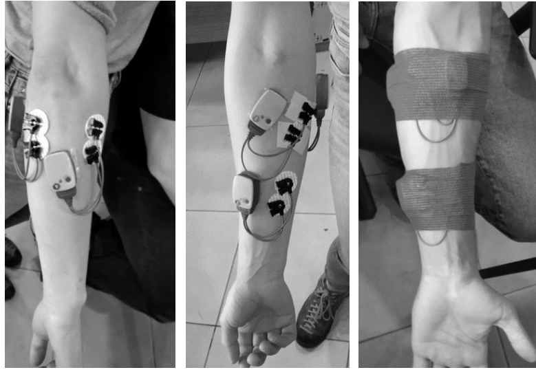
Şekil 3.34. Ön kolda FG, FDS, FDP ve ED üzerinde EMG sensörü uygulaması.
