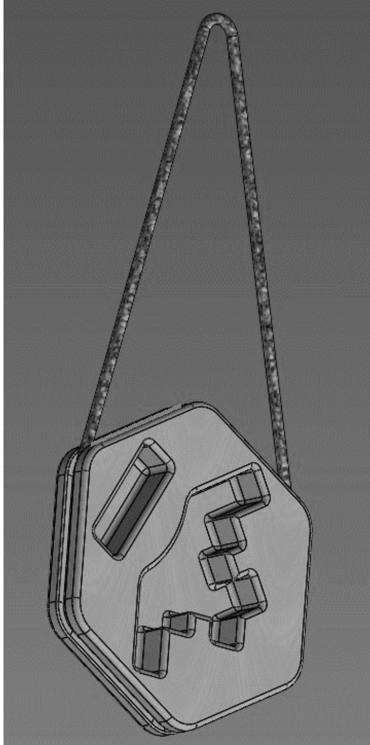
Şekil 6.1. Parmak eklem pozisyonlarına göre özel imal edilmiş izometrik tutunma antrenmanı enstrümanı.
