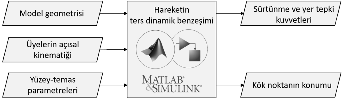
Şekil 3.37. Simulink'te hareketin ters dinamik benzeşimiyle sürtünme ve yer tepki kuvvetlerinin hesaplanması işleminin akış şeması.
