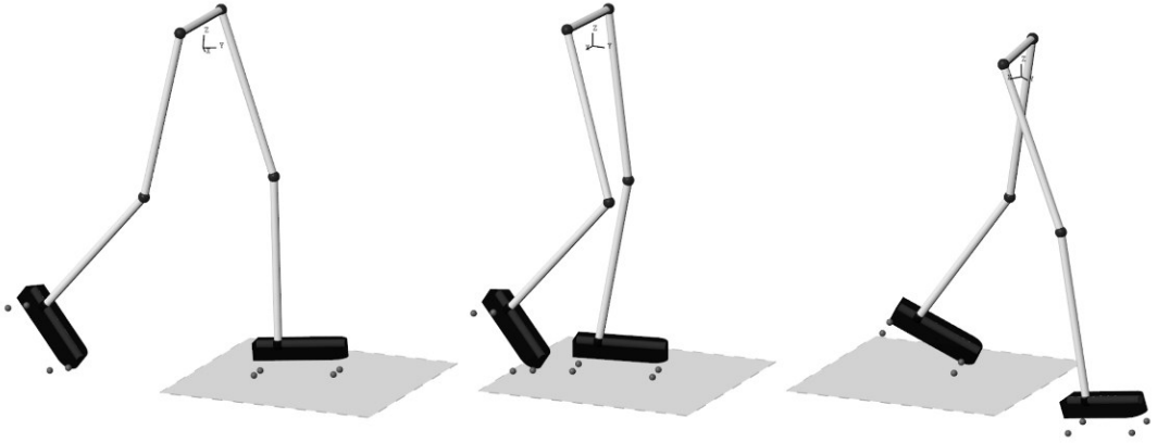
Şekil 3.42. Simulink'te HY02 hareketinin ters dinamik benzeşimi.
