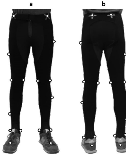
Şekil 3.10. Nexus'un CGM2 modelinde bulunan yansıtıcı işaretlerin aktör üzerindeki yerleşiminin (a) önden ve (b) arkadan görünümü.
