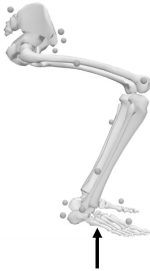
Şekil 3.61. OpenSim’de yer tepki kuvvetlerinin ve sürtünme torkunun calcaneus geometrisinin kütle merkezinden uygulanması.
