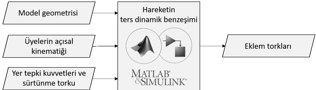
Şekil 3.53. Simulink'te hareketin ters dinamik benzeşimiyle eklem torklarının hesaplanması işleminin akış şeması.
