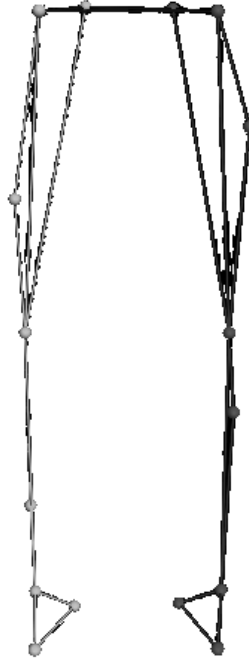
Şekil 3.16. Hareketler sırasında aktörün üzerinde bulunan ve ölçeklenen CGM2 modeli kullanılarak etiketlenen yansıtıcı işaretler.
