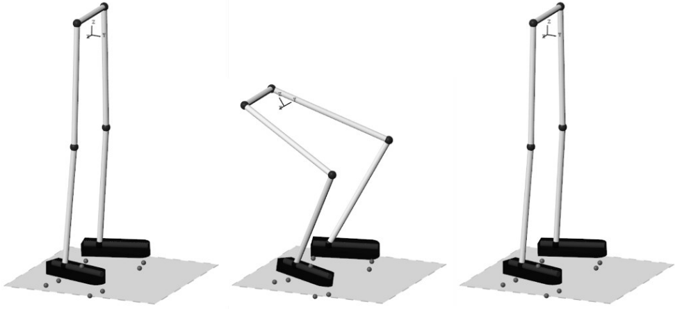
Şekil 3.41. Simulink'te HY01 hareketinin ters dinamik benzeşimi.
