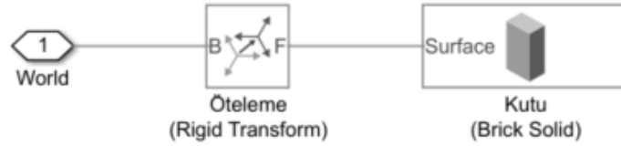
Şekil 3.26. Simulink ortamında HY03 hareketi için kutunun modellenmesi ve World Frame ile bağlantısı.
