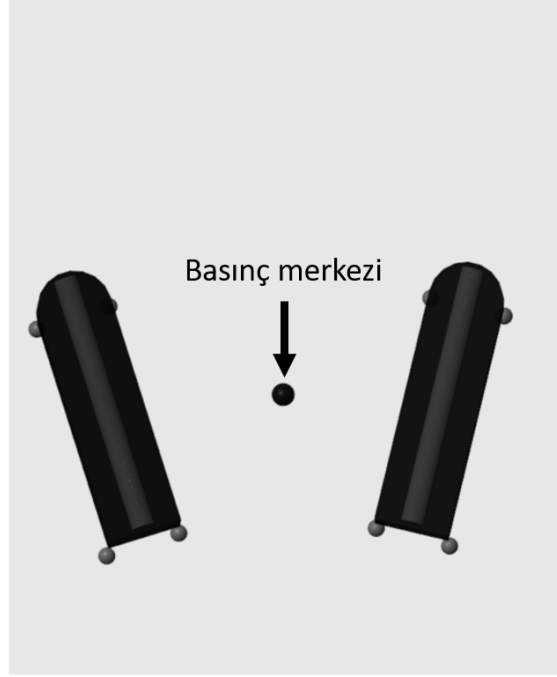
Şekil 3.51. Simulink'te basınç merkezinin transvers düzlemdeki konumunun görselleştirilmesi.
