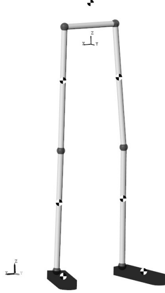
Şekil 3.28. Simulink ortamında oluşturulan 7 üyeli katı cisim modeli.
