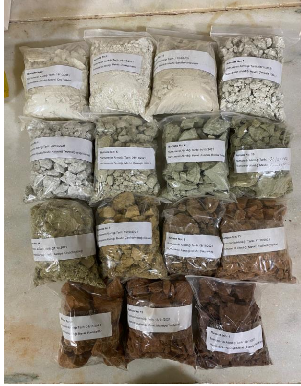
Görsel 1. Kil numunelerinin XRF analizi için hazırlanması, (Kişisel Arşiv).
