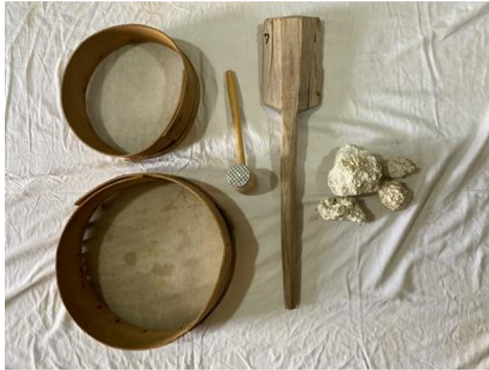
Görsel 2. Geleneksel yöntem ile kil eleme-I, (Kişisel arşiv).
