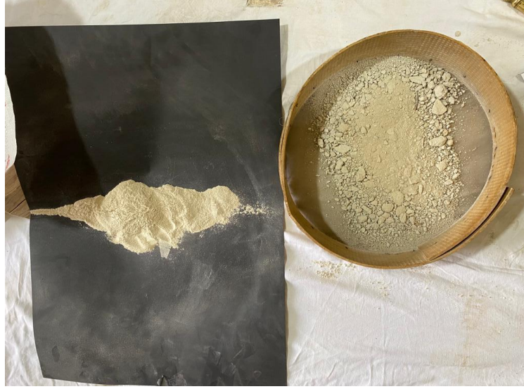
Görsel 3. Geleneksel yöntem ile kil eleme-II, (Kişisel arşiv).
