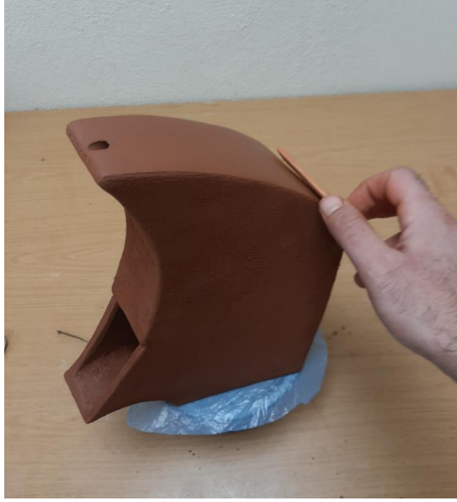
Görsel 41. Kayahan Dönmez, 2021. Bütünleştirme işlemi bitirilmiş formun perdahlama işlemi (Kayahan Dönmez, kişisel fotoğraf arşivi).
