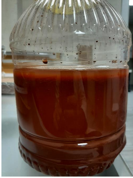
Görsel 47. Kayahan Dönmez, 2021. Astar karışımının 48 saat dinlendirilmiş hali. (Kayahan Dönmez, kişisel fotoğraf arşivi).
