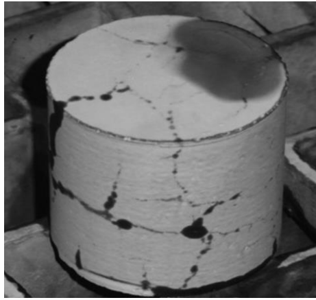
Şekil 3.2. 60 sn mikrodalga uygulanması ile numunede oluşan çatlaklar (Hartlieb vd., 2012).
