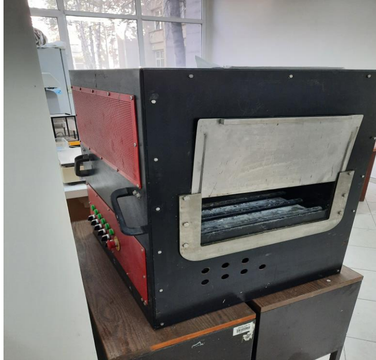
Şekil 4.14. 2.45 GHz frekans ve 6 kW güce sahip endüstriyel kapalı tip mikrodalga fırın
