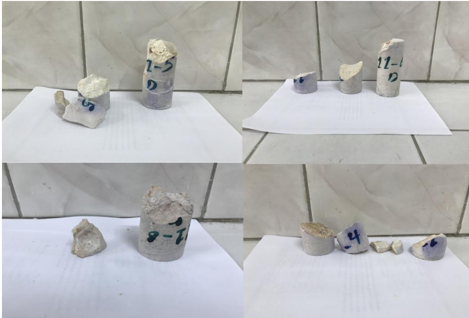
Şekil 5.33. Mikrodalga sonrası patlayan Amasya kireçtaşı numunelerinden bir kısmı.
