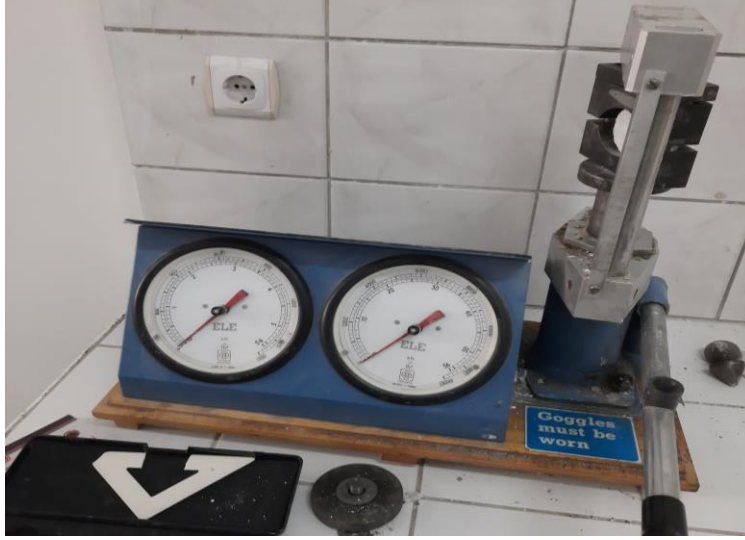
Şekil 4.13. Nokta yük deney aletinde Brazilian çekme deneyi yapılışı.
