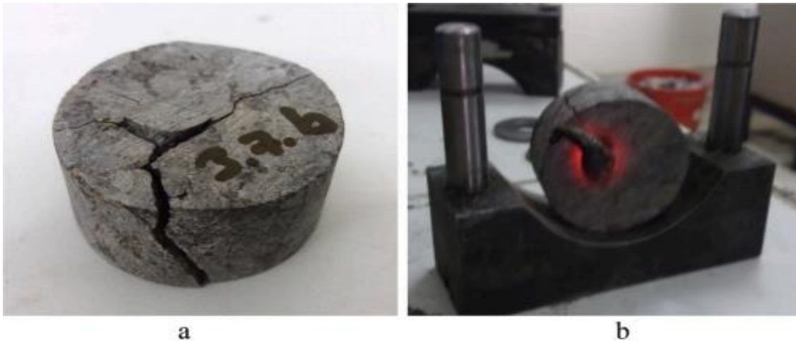
Şekil 3.3. Siyenit üzerinde 60 sn (a) ve 120 sn (b) 6 kW gücünde mikrodalga uygulama sonrası görülen çatlama ve ergime (Kahraman vd., 2020).
