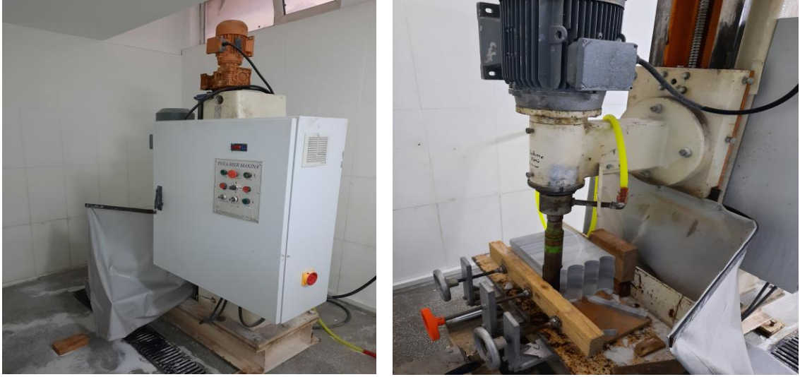
Şekil 4.1. Karot alma makinesi ve karot alma işlemi.
