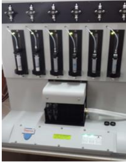
Şekil 3.2. Otomatik Katı Faz Ekstraksiyon Sistemi.
