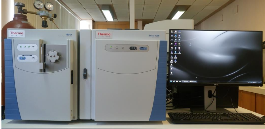
Şekil 3.6. Gaz Kromatografisi-Kütle Spektrometresi cihazı.
