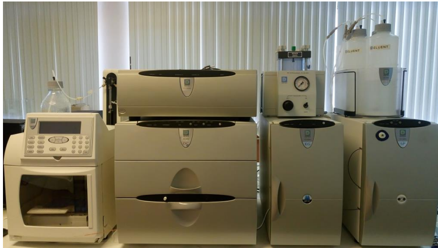
Şekil 3.4. İyon Kromatografisi cihazı.
