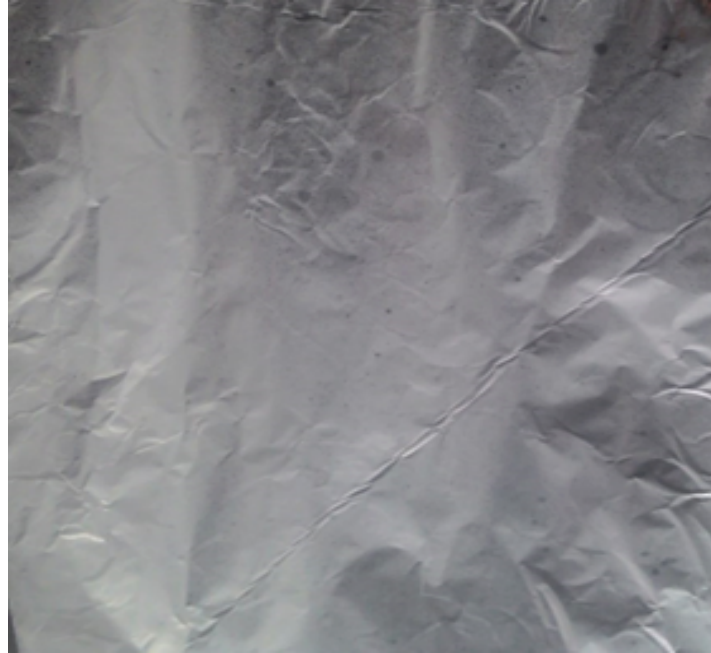
Şekil 13. Toplayıcı Plaka Üzerine Kaplanmış Olan Alüminyum Folyo Üzerine Tam Toplanamamış PLLA Nanolifler
