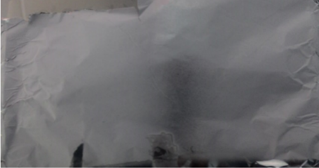
Şekil 14. PLLA Polimerinin Elektroçekim İşleminde Toplayıcı Plaka Üzerinde Homojen Olarak Dağılmamış Olan Nanolif
