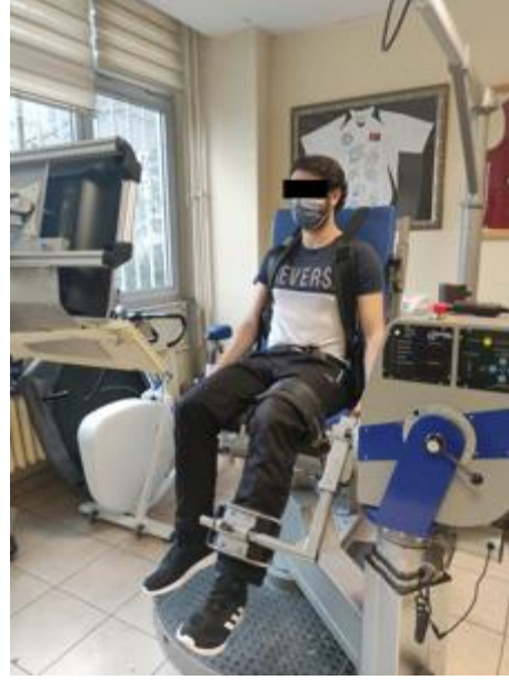
Şekil 3.2. İzokinetik Dinamometre ile Diz Kas Kuvvetinin Değerlendirilmesi
