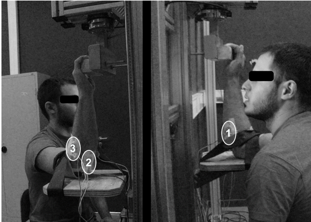
Şekil 4.4. EMG yüzey elektrotlarının yerleştirildiği yerler. 1 ve 2 nolu elektrotlar fleksör grup kaslarının (FDS, FDP) aktivitesini, 3 nolu elektrot ise ekstansör grup kaslarından EDC'nin aktivitesini değerlendirmek için kullanılmıştır.
