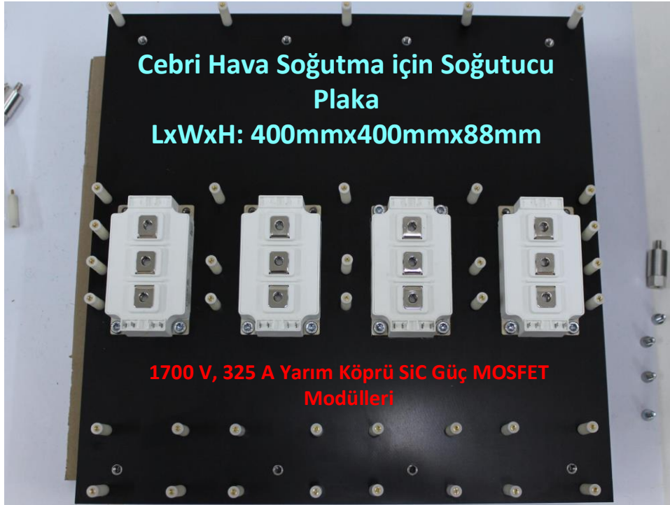
Şekil 2.12. Fischer Elektronik SK461-400 Soğutucu Plaka ve SiC Güç MOSFET'leri yerleşimi
