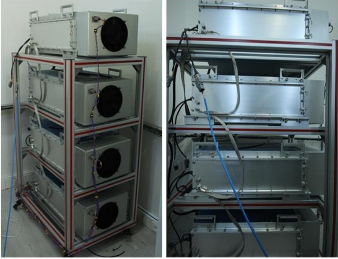
Şekil 4.5. Laboratuvar Ortamında Kurulmuş Olan 4 Adet Süperkapasitör Bankası Raf Yerleşimi
