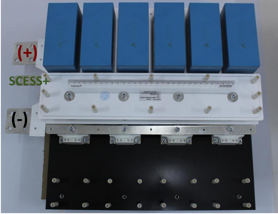
Şekil 2.17. Lamine Bara Üzerine Montajlanmış Yüksek Frekans Akım/EMI Filtre Kapasitörleri
