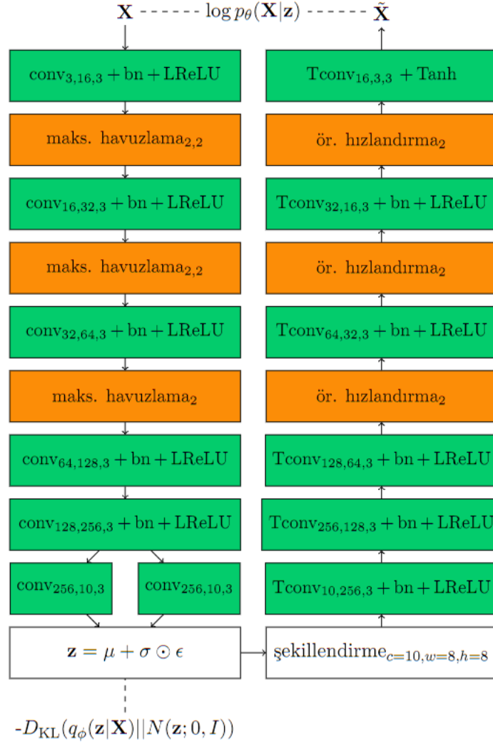
Şekil 5.1. İlk sütundaki bloklar, kodlayıcıyı temsil eder. Kodlayıcı, gizli değişken vektörü \mathbf{z} 'yi elde edebilmek için gerekli parametreleri, beş evrişimsel (conv), üç maksimum ortalama ve evrişimsel darboğaz katmanları ile elde eder. İkinci sütundaki bloklar ise kodçözücüü ifade eder. Kodçözücü, \mathbf{z} 'den girdi görüntüsünü geriçatmak için altı devrik evrişimsel (Tconv) ve üç örnekleme hızlandırma (upsampling) katmanı kullanır. bn ve LReLU, sırasıyla toplu normalleştirme (batch normalization) ve kaçak doğrultmaçlı aktivasyon biriminin kısaltmalarıdır [1].
