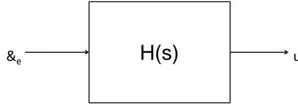
Şekil 3.6. Giriş \delta_e İrtifa Dümeni Açısı (rad) ve Çıkışı Uçağın İlerleme Hızı u (ft/s) için Dinamik Model
