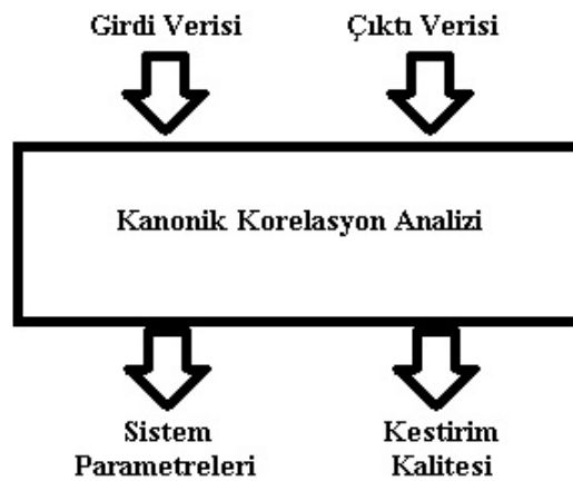
Şekil 3.2. Kanonik Korelasyon Analizi ile Sistem Tanıma Şematiği
