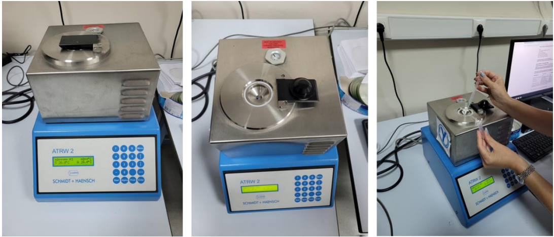
Şekil 3.1. Refraktif indeks ölçümü.
