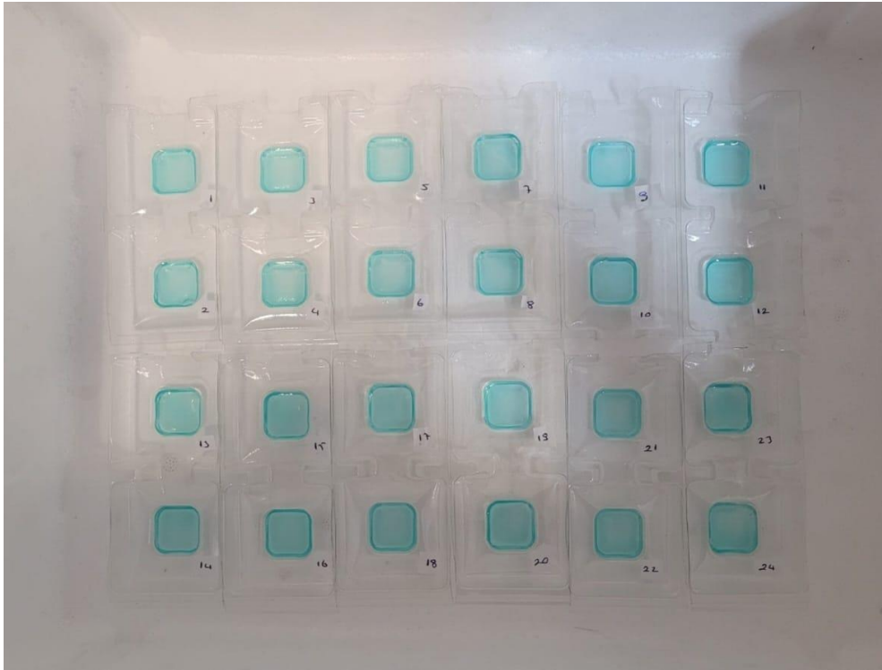
Şekil 3.6. Kalıplara aktarılan sıvı film içeriklerinin görüntüsü.
