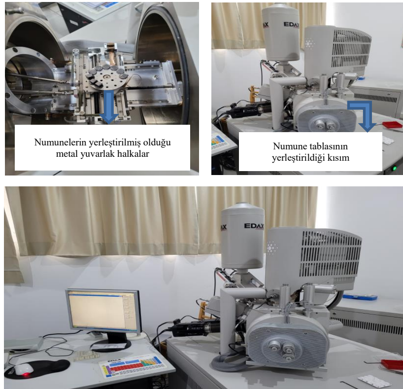
řekil 3.2. SEM analizleri sırasında hazırlanan numuneler ve görüntüleme cihazı.
