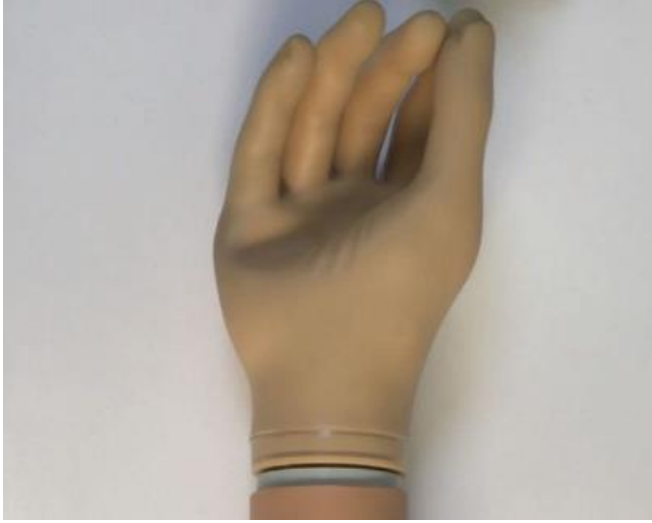
Şekil. 2.4. Myoelektrik protez el (terminal uç) üzerindeki eldiven
