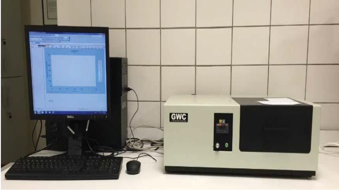
Şekil 3.8. PEN-G baskılanmış MIP-AuNPs, baskılanmamış NIP-AuNPs ve AuNPs'ler eklenmeden hazırlanan SPR nanosensörlerin kinetik analizlerinin yapıldığı SPR ölçüm cihazının görüntüsü.
