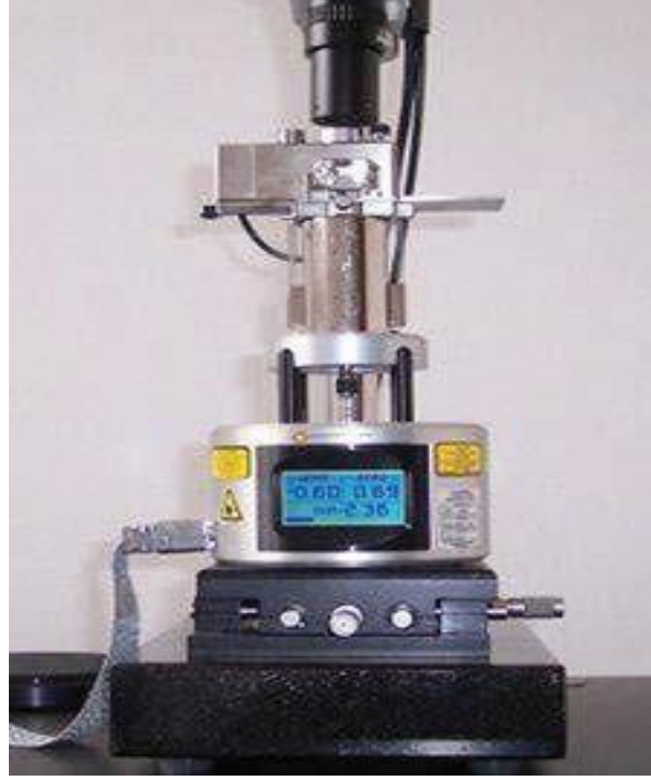
Şekil 3.5. PEN-G baskılanmış MIP-AuNPs ve baskılanmamış NIP-AuNPs SPR nanosensörlerin yüzey karakterizasyonu için kullanılan Atomik Kuvvet Mikroskobu cihazının görüntüsü.
