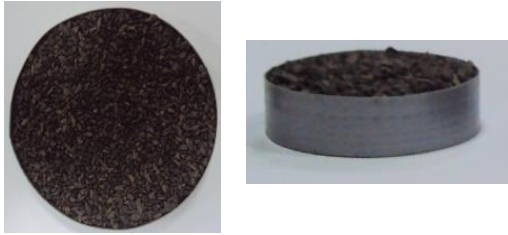
Şekil 11. Karıştırmalı değirmen modeli için kullanılan sıkıştırılmış yatağın fotoğrafları
