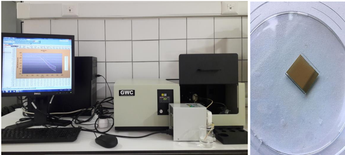
Şekil 3.5. SPR biyosensör sistemi ve altın çip görüntüsü.
