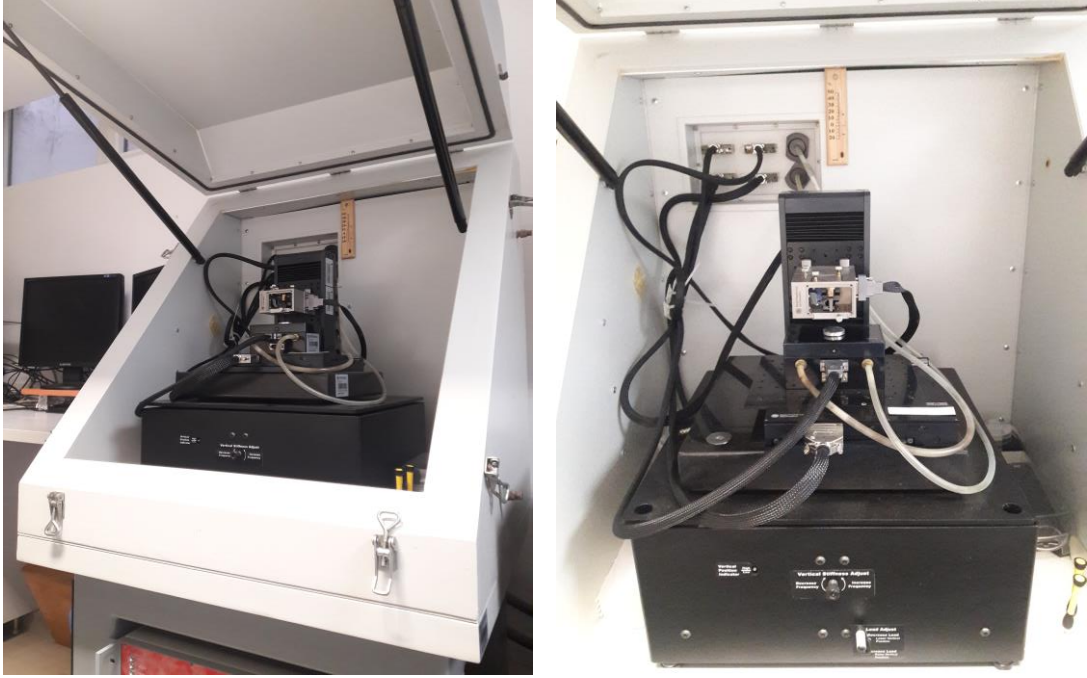
Şekil 3.3. Atomik Kuvvet Mikroskobu (AFM) cihazı görüntüsü.
