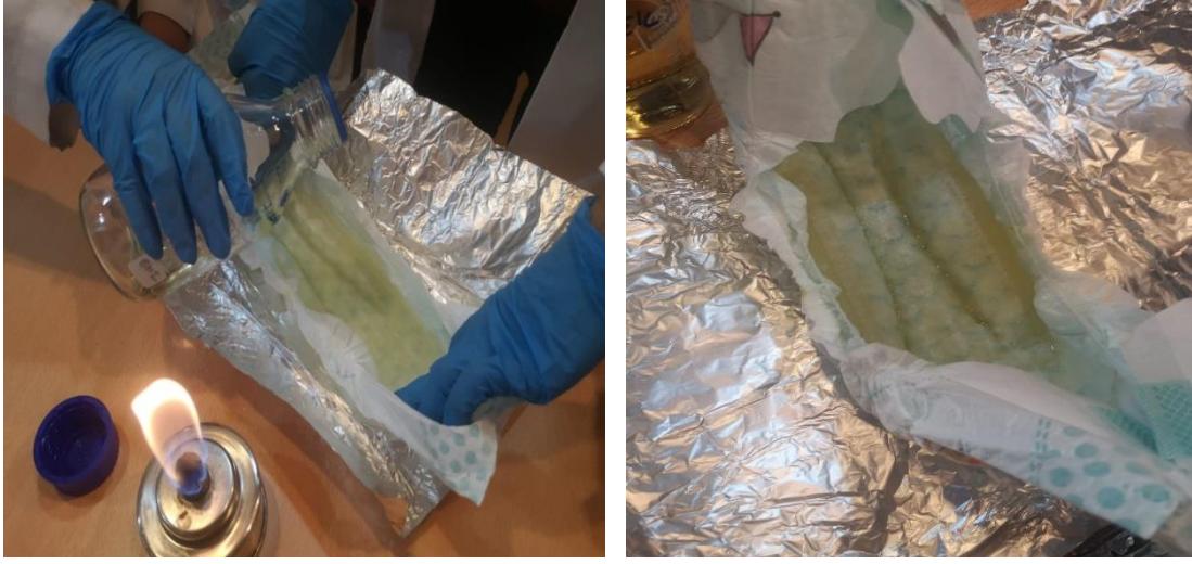
Şekil 3.4. Propolis emdirilmiş bebek bezlerine 350 mL NB ve 1 mL bakteri/maya kültürü karışımının uygulanması (Fotoğraf:Osmancan Takmaklı).
