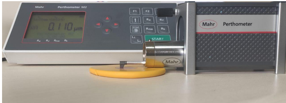
Şekil 3.25. Perthometer M2 (Mahr GmbH, Göttingen, Almanya) profilometre cihazı ile yüzey pürüzlülüğü ölçümü.
