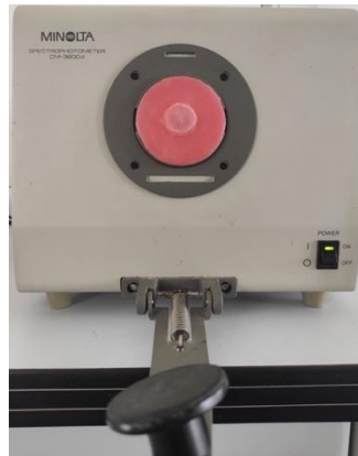
Şekil 3.34. Konica Minolta CM 3600d spektrofotometre ile renk ölçümü.
