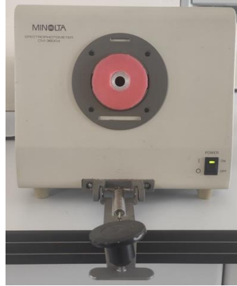
Şekil 3.33. Konica Minolta CM 3600d spektrofotometre ile renk ölçümü.
