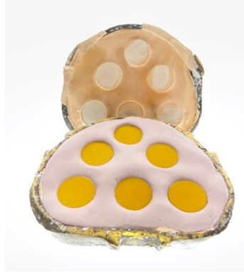
Şekil 3.7. Konvansiyonel Isıyla Polimerize PMMA örneklerin üretileceği muflaların hazırlanması.
