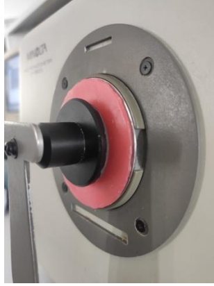
Şekil 3.32. Konica Minolta CM 3600d spektrofotometre ile renk ölçümü.
