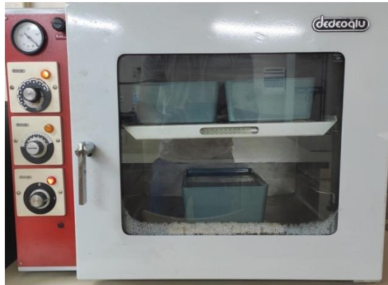
Şekil 3.30. Örneklerin distile su, kahve ve şarap solüsyonlarında 37 °C'de etüvde bekletilmesi.
