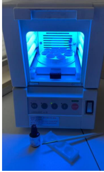
Şekil 3.22. GC Labolight LV-III'da Optiglaze Color Clear polimerizasyonu.
