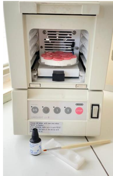
Şekil 3.21. GC Labolight LV-III'da Optiglaze Color Clear Polimerizasyonu.
