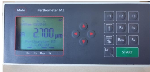
Şekil 3.23. Yüzey pürüzlülüğü ölçümü öncesi Perthometer M2 (Mahr GmbH, Göttingen, Germany) profilometre cihazının kalibrasyonu.
