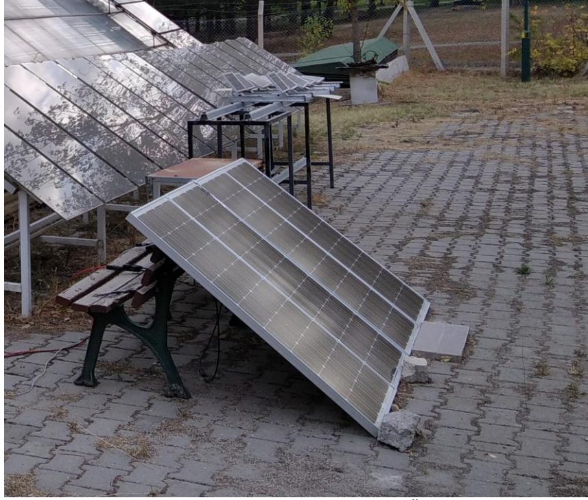
Şekil 4.3.a. 3'lü Batarya Grubu Deney Seti (Dış Ünite)
