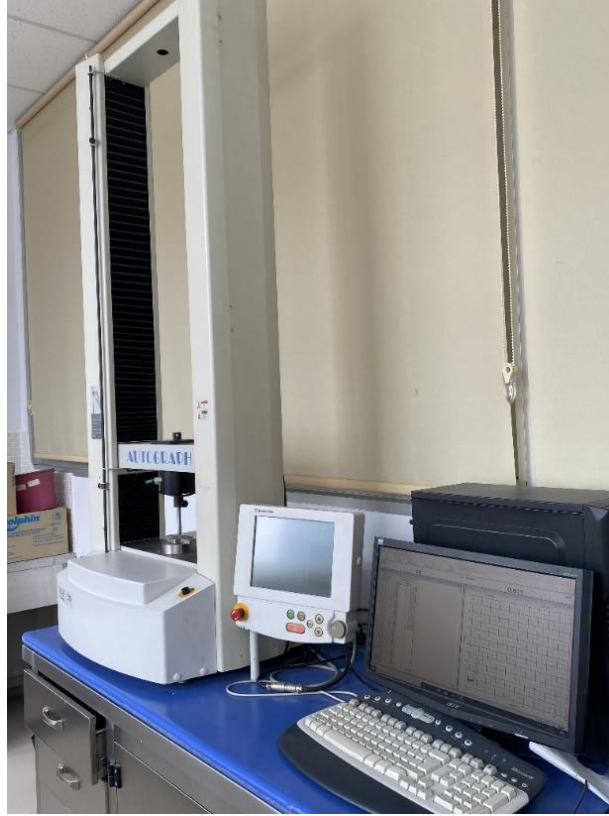
Şekil 3.11. Push-out testinde kullanılan evrensel test cihazı.
