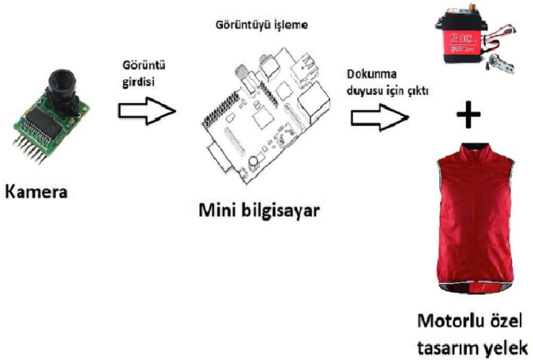
Şekil 3.1. Yapay Görme Sisteminin şematik yapısı
