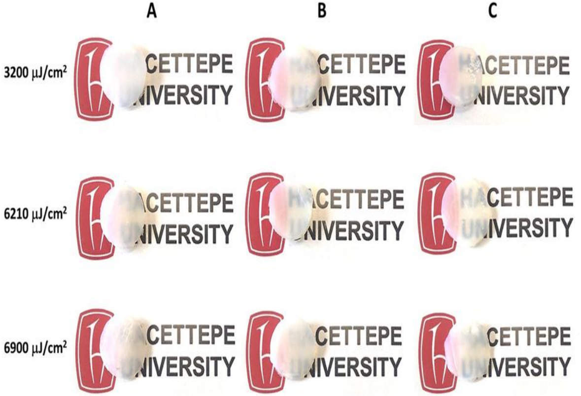
Şekil 4.13. Farklı enerji yoğunlukları ile farklı sürelerde GelMA ile emdirilen hibrit matrislerin şeffaflık üzerindeki etkilerini gösteren görüntüler. Gruplar 3200 \mu\text{J}/\text{cm}^2 , 6210 \mu\text{J}/\text{cm}^2 ve 6900 \mu\text{J}/\text{cm}^2 UV ışığına (365 nm) maruz bırakılmıştır. 200 \mu\text{L} GelMA polimeri üzerine emdirildikten hemen sonra çapraz bağlanmış yapılar (A), 5 dakika sonra (B), 24 saat sonra GelMA emdirilmiş hibrit matrisler (C).
