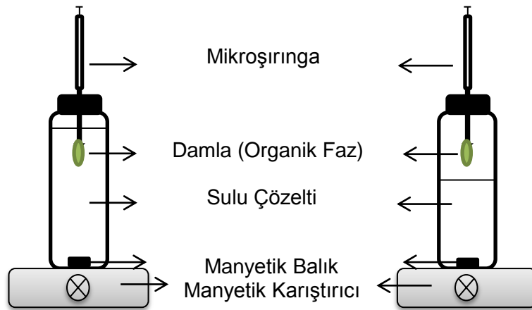
Şekil 2.9. (a) DI-SDME, (b) HS-SDME yöntemi şematik gösterimi
