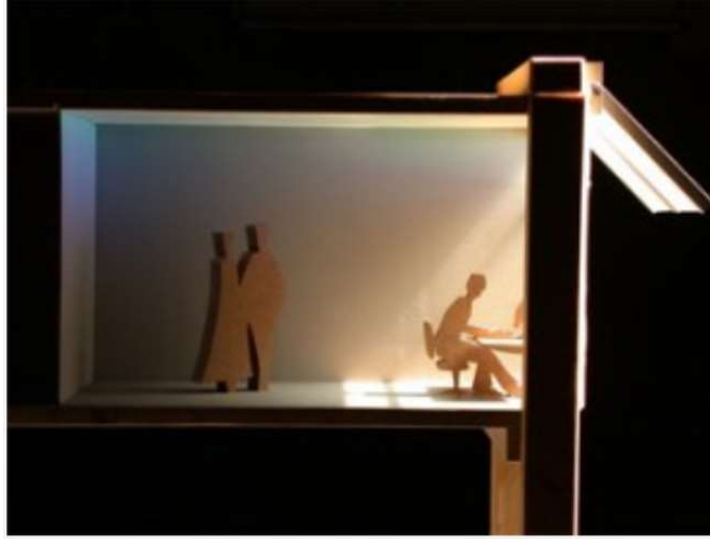
Görsel 8. HOE ışık yönlendirmeli bir ofis odasının ölçekli modeli. Hochschule Wismar, Germany.
