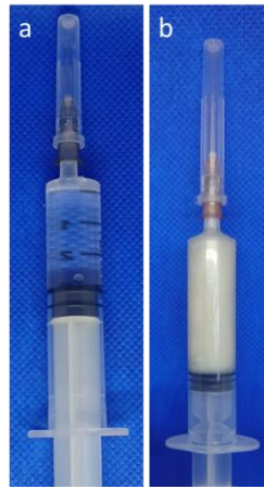
Şekil 3.3. Aseton içerisinde çözülmüş PCL ve PCL-AgNT çözeltileri.
