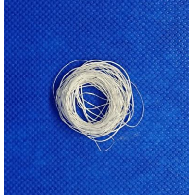
Şekil 4.3. Yüksek molekül ağırlıkta fiziksel bütünlüğe sahip, PCL80kDa fiber iskele görüntüsü.
