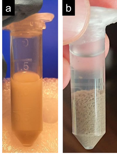
Şekil 4.36. ST-AgNT kompleksi (a) Etanol içerisinde dağılık halde bulunan AgNT dispersiyonu ve (b) ST karıştırıldıktan sonra etanol ile oluşan faz ayrımı görüntüleri.
