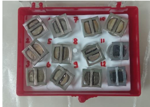
Şekil 3.8. SEM analizi için hazırlanan yüzeyi altın kaplanmış hücreli örnekler.
