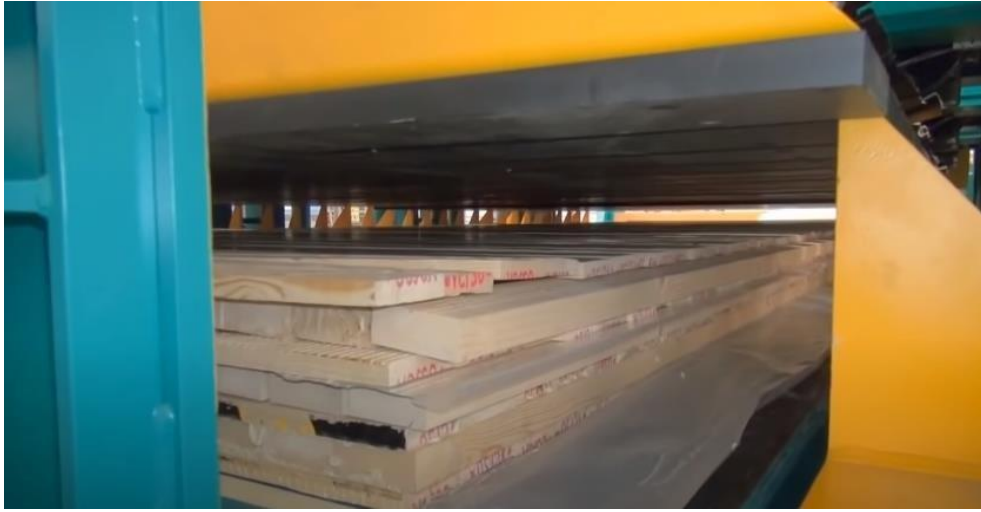
Şekil 4.10. : Ahşap malzemenin pressleme işleminden sonraki görünümü [30].
