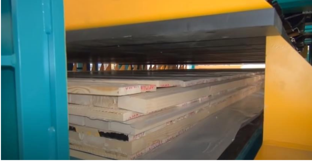
Şekil 4.9. : Ahşap malzemenin sıkıştırma aşaması [30].
