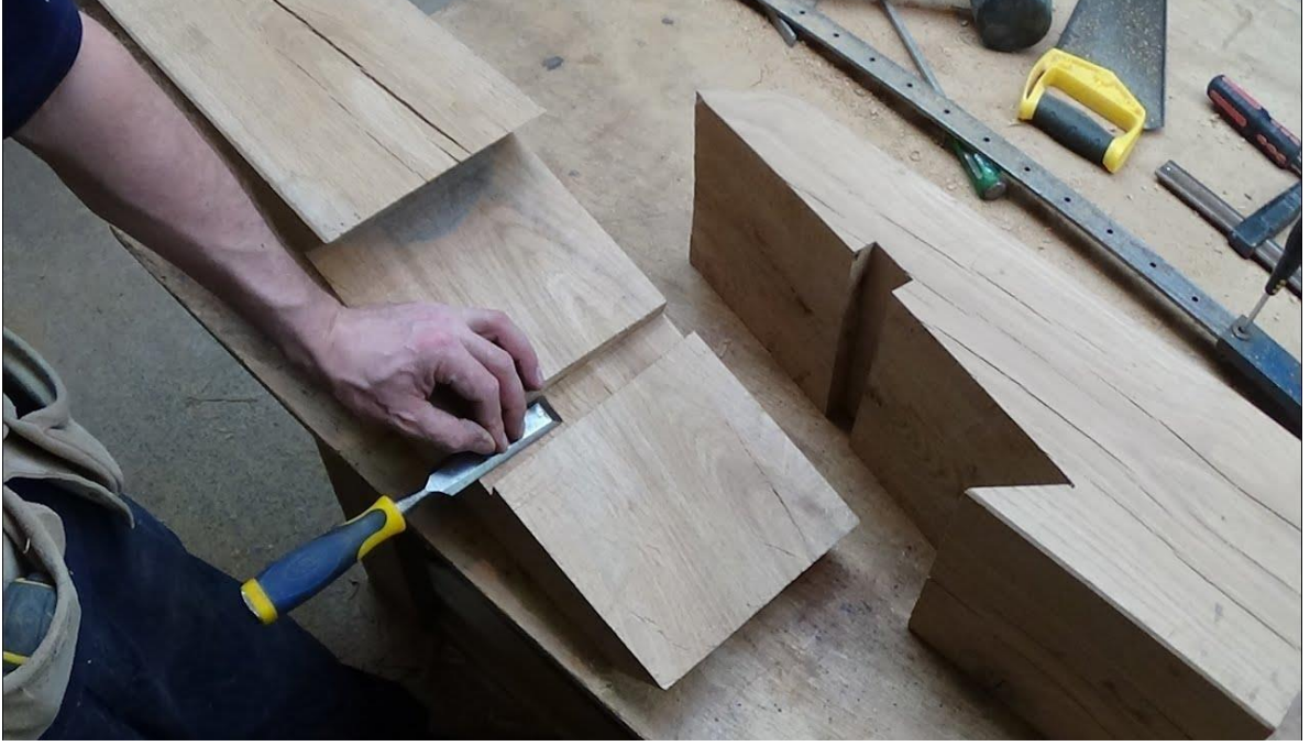
Şekil 5.9. : Uçuca eklemeli bağlantı elemanları hazırlanması [43].
