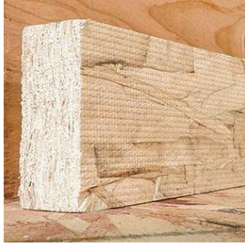
Şekil 4.15. : OSB uygulaması ile üretilmiş ahşap malzeme örneği [37].
