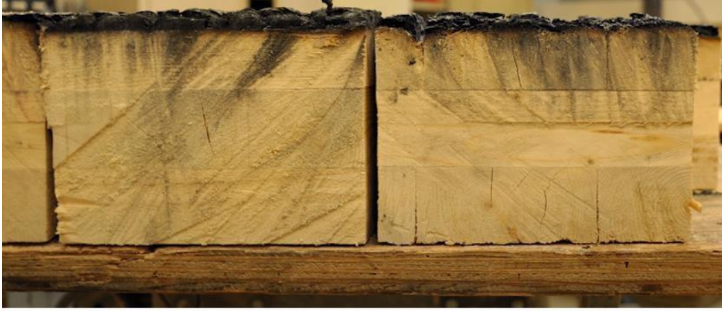
Şekil 10.2. : Laminasyon tekniğiyle üretilmiş (CLT) ahşap malzemenin deney sırasında sonraki görüntüsü [99].
