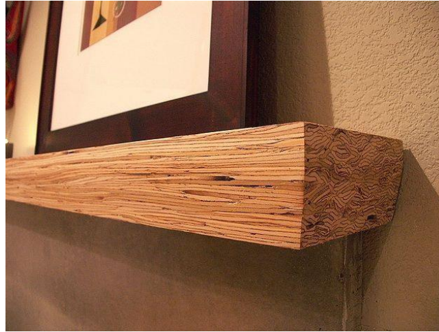
Şekil 4.12. : LVL-MİCROLAM uygulaması örneği [34].
