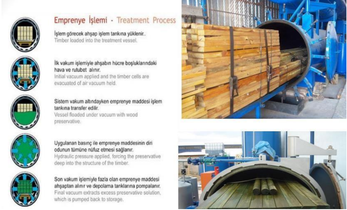
Şekil 3.7. : Basınç uygulanarak emprenye işlemi aşamaları [12].
